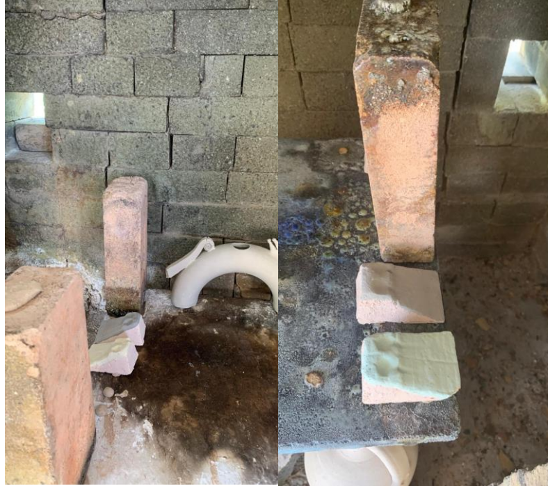
Görsel 29: Soda fırınına sır deneme tabletleri yerleştirme (Dilek Kocakaplan, kişisel arşiv)
