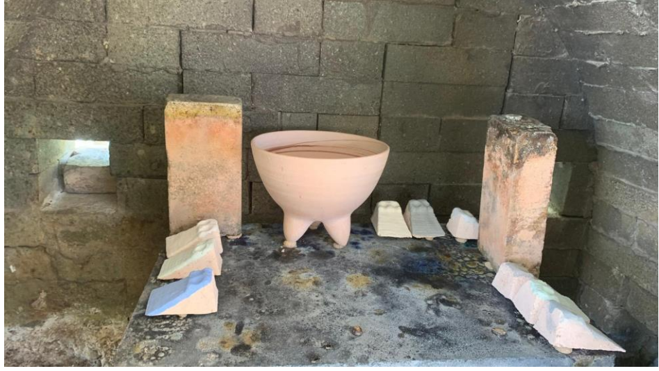
Görsel 30: Soda Fırınına Sır Tabletlerinin Yerleştirilmesi,07.09.2024
