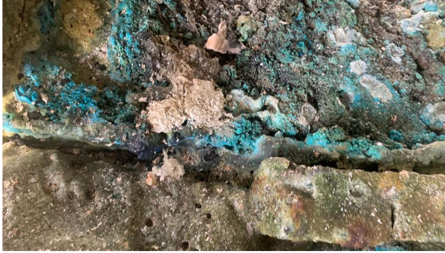
Görsel 16: Soda Fırının İçinde Oluşan Soda Kalıntıları, Kaynak (Dilek Kocakaplan, Arşivinden)
