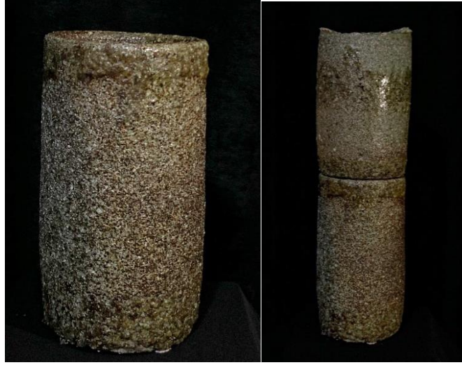
Görsel 46: Künk Soba Baca Boruları, Sır Reçetesi 5'e Ait, Yeşilimtırak, Parlak Sır, 1225°C
