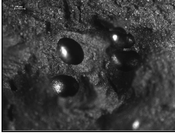
Şekil 6.8. % 20 talk katkılı PP malzeme - % 8 MuCell mikroskop görüntüsü (x80 büyütme)
