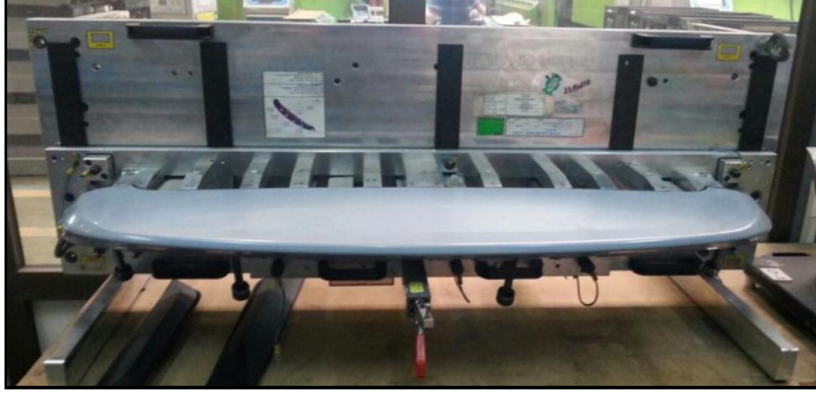
Şekil 5.7. Üst rüzgarlık parçası fikstürü
