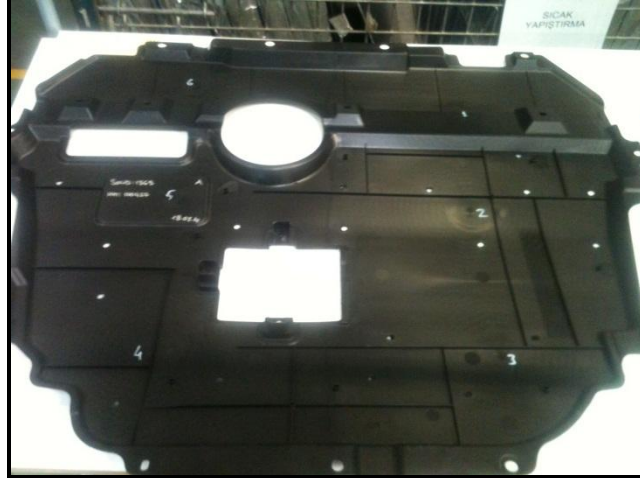
Şekil 5.10. Motor alt kapama parçası arkadan görünümü
