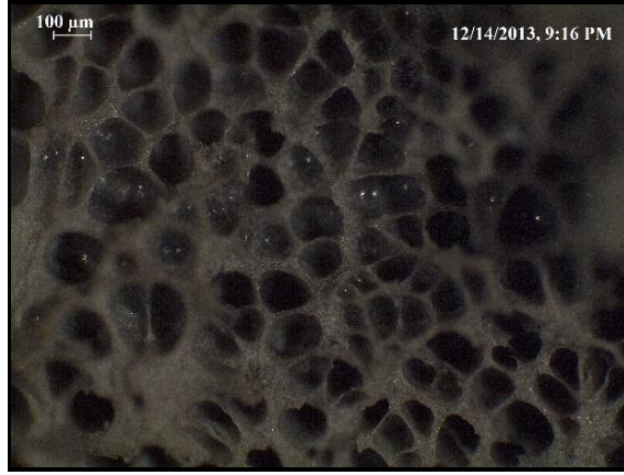
Şekil 6.14. ABS malzeme - % 8 MuCell mikroskop görüntüsü (x80 büyütme)
