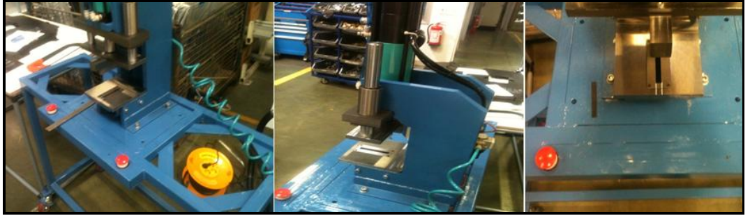
Şekil 5.11. Test numunesi kesme aparatı
