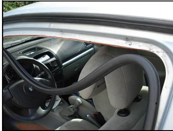
Şekil 1.10. Ekstrüzyon ile üretilmiş termoplastik elastomer conta
