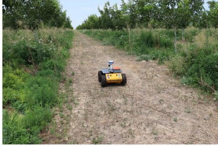
Şekil 2. 1. Tarımsal amaçla tasarlanan 'Husky' robotu. (Asiminari ve diğ.,2024)
