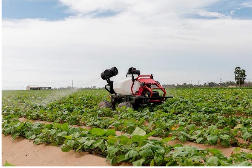
Şekil 2. 2. İlaçlama uygulamasında kullanılan XAG R150 model İKA (URL-7)
