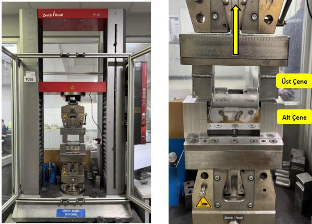
Şekil 6.8. Zwick marka çekme test cihazı ve iş parçası
