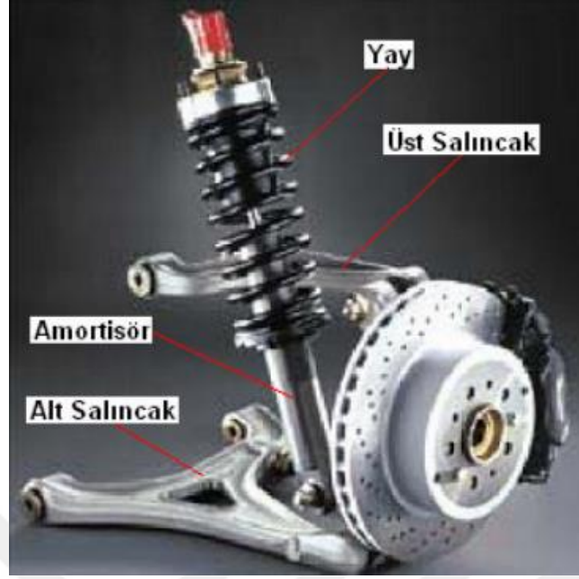
Şekil 4.2. Süspansiyon sisteminin kısımları (Ergin, 2006)
