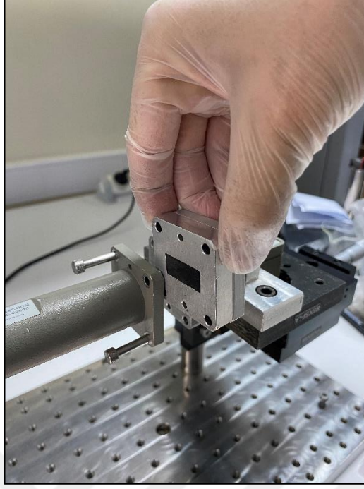
Şekil 4.21. Katmanlı numunenin yerleştirildiği örnek tutucunun dalga kılavuzuna yerleştirilmesi
