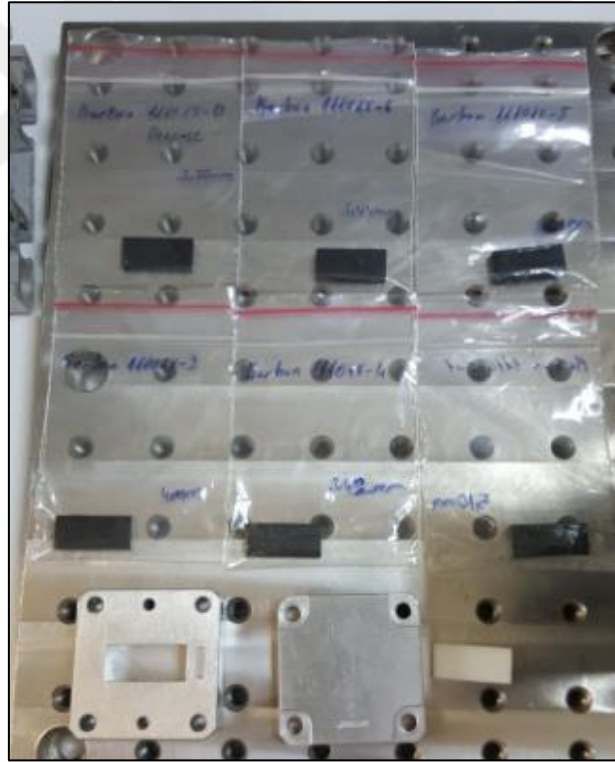
Şekil 4.11. X-Band dalga kılavuzu numune tutucusu boyutlarında hazırlanmış numuneler
