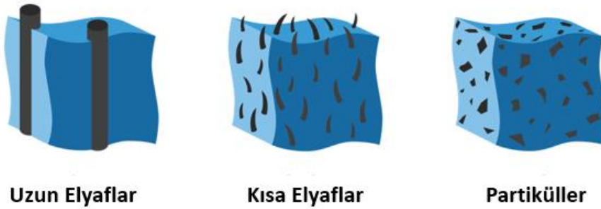
Şekil 2.3. Uzun elyaf, kısa elyaf ve partikül takviyesinin gösterimi (URL-1)
