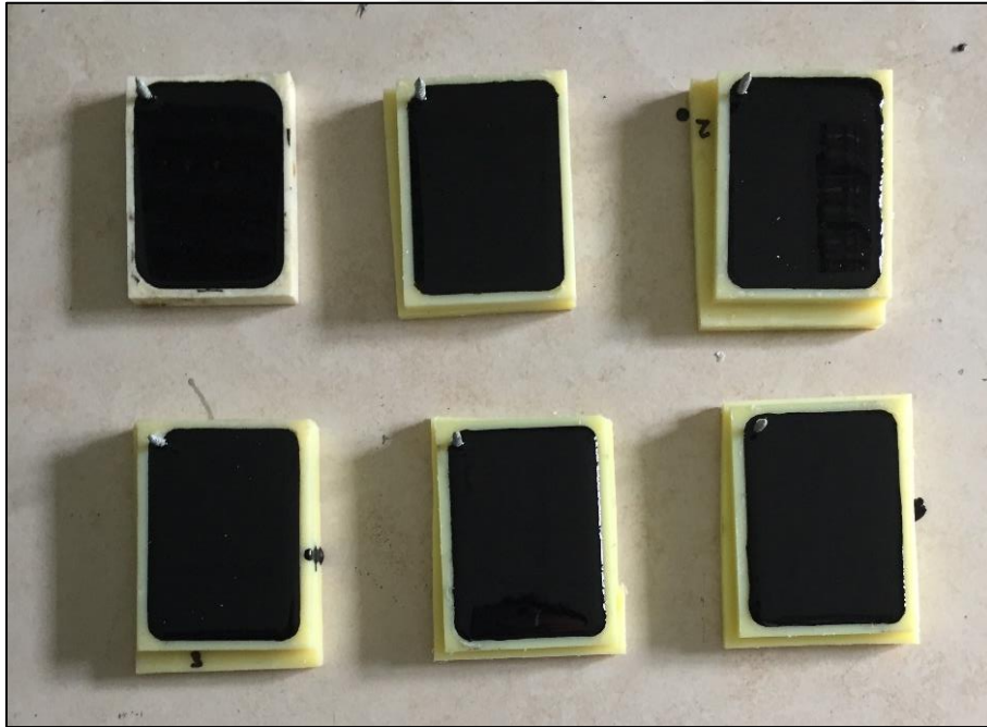
Şekil 4.8. Kestamid kalıplara dökülmüş numuneler
