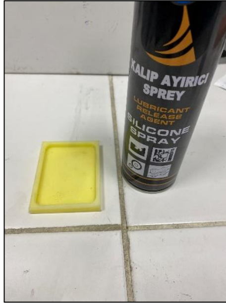
Şekil 4.4. Kestamid kalıbın kalıp ayırıcı ile hazırlanması
