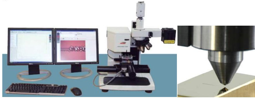
Şekil 3.18: Yüzey çizilme (Scratch) test cihazı ve Rockwell S-218 tipi batıcı uç
