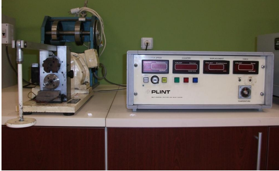
Şekil 3.16: “Plint” marka “Pin on Ring” tipi çok amaçlı sürtünme aşınma cihazı
