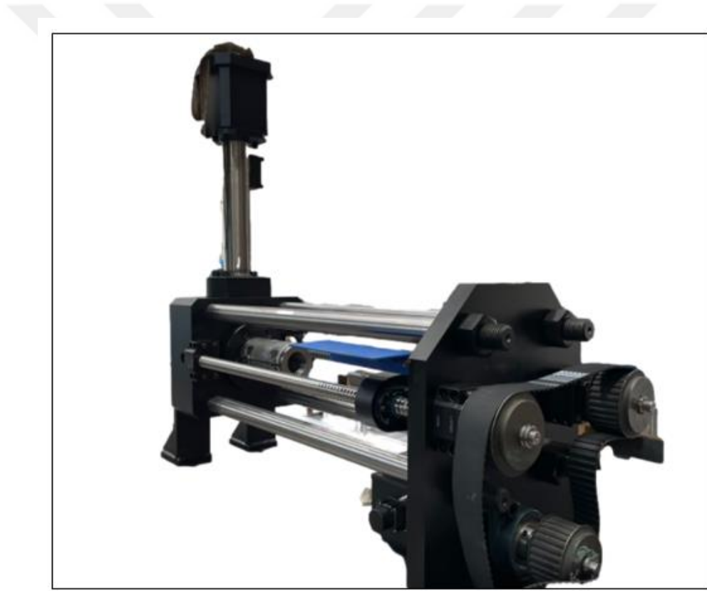
Şekil 3.7. Geliştirilmiş reolojik karakterizasyon test cihazı tahrik mekanizması
