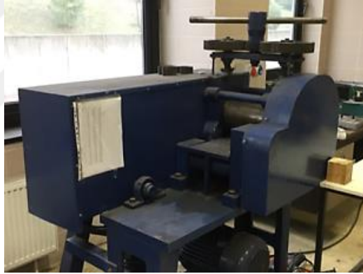
Şekil 3.2. Soğuk deformasyon prosesleri için kullanılan hadde tezgahı
