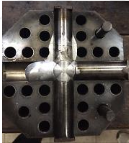
Şekil 3.7. Proses sonrası açılmış EKAP kalıbı ve aşırı deforme edilmiş parça
