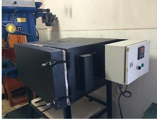
Şekil 3.5. EKAP prosesi düzeneğine ait ısıtıl işlem fırını
