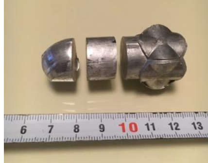
Şekil 3.8. Aşırı deformasyon uygulanmış parçadan alınan numunelere ait makro bir görsel
