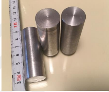
Şekil 3.1. Temin edilmiş malzeme olarak tanımlanan alaşımların tornalama sonrası makro görseli
