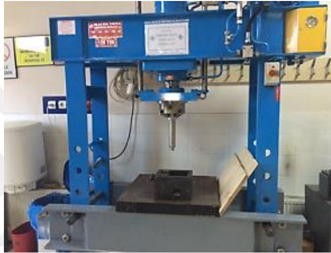
Şekil 3.4. EKAP prosesinde kullanılan hidrolik pres, kalıp tutucusu ve plaka
