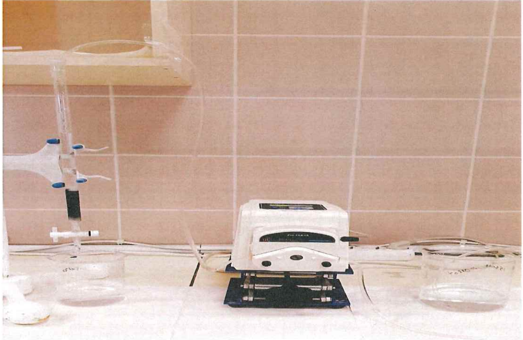
Şekil 4.10. LABSA adsorpsiyon kolon deney düzeneği
