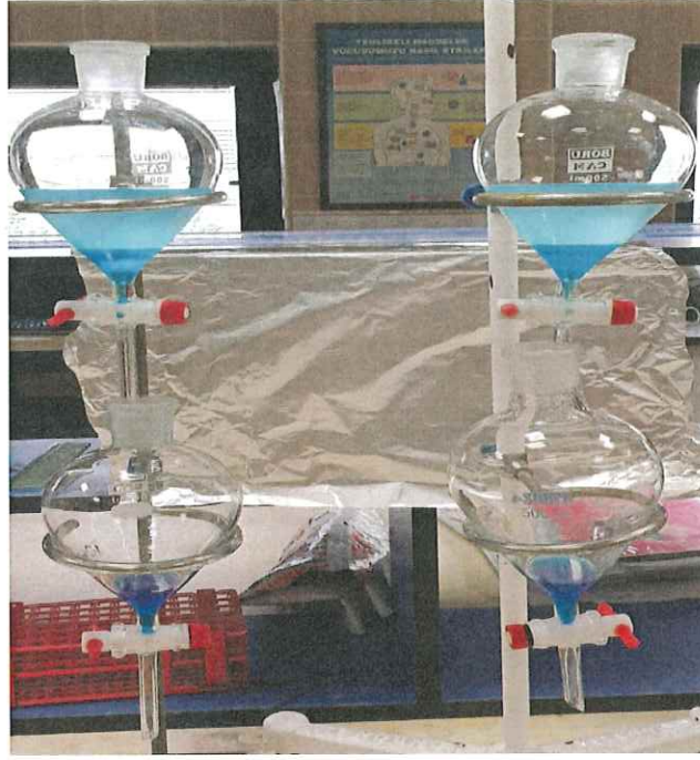
Şekil 4.11. MBAS yöntemi ile deterjan analizi
