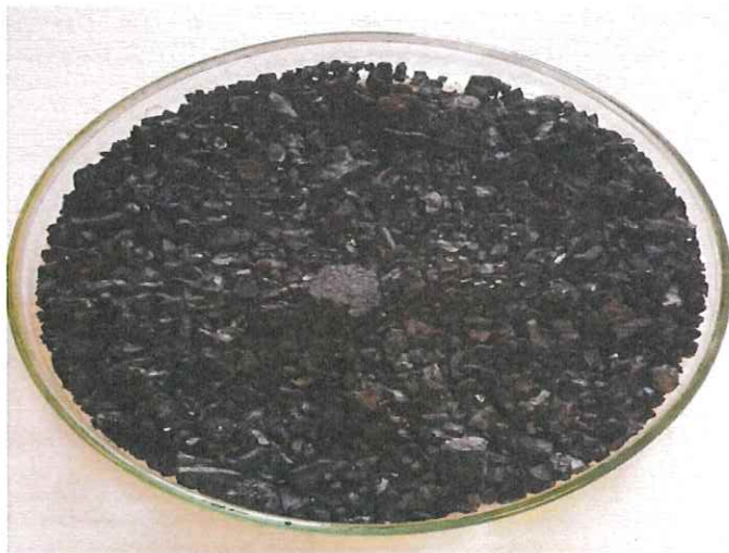
Şekil 4.6. Karbonizasyon işlemi sonrası ceviz kabuğu
