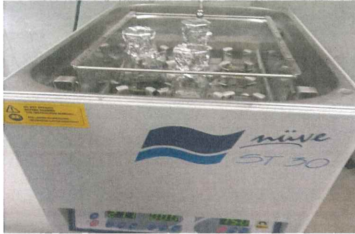
Şekil 4.5. Ceviz kabuklarının H_3PO_4 ile aktivasyonu
