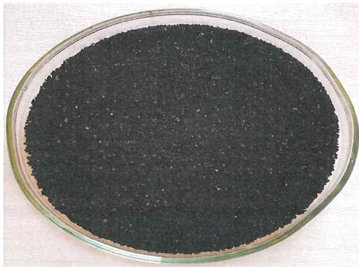
Şekil 4.8. Polimerizasyon sonrası ceviz aktif karbon
