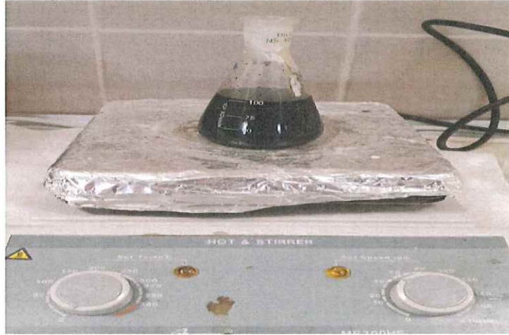
Şekil 4.7. Ceviz aktif karbonun anilin ile polimerizasyonu
