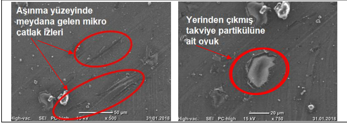
Şekil 3.47. %10 olivin takviye edilmiş PPS kompozitlere ait adhezif aşımaya maruz yüzeyine ait SEM fotoğrafları
