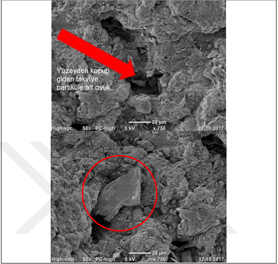
3.92 (Devamı). %10 fıstık kabuğu takviye edilmiş numunelerin 30° çarpma açısında aşındırılmış yüzeylere ait SEM fotoğrafları
