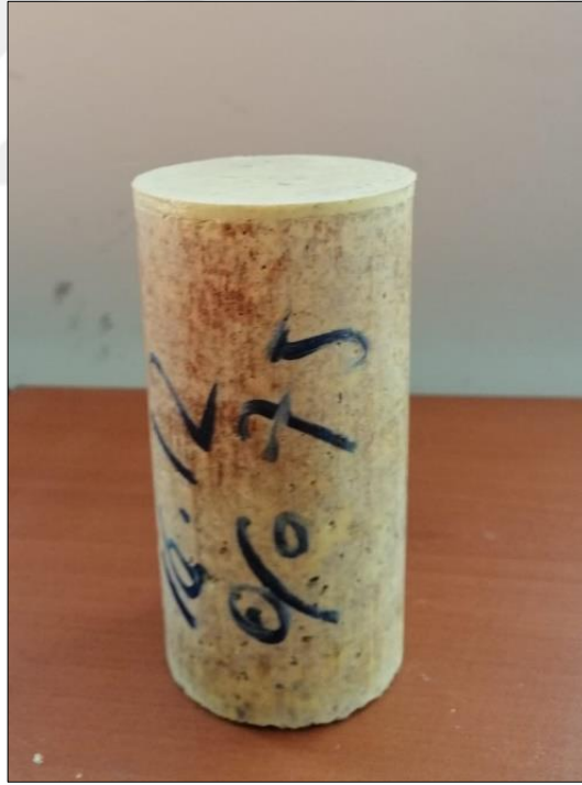
Şekil 5.23. Kükürt enjekte edilmiş zemin numunesi
