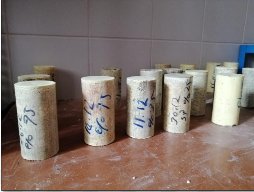
Şekil 5.25. Serbest basınç deneyine hazır, farklı rölatif sıklıkta hazırlanan numuneler
