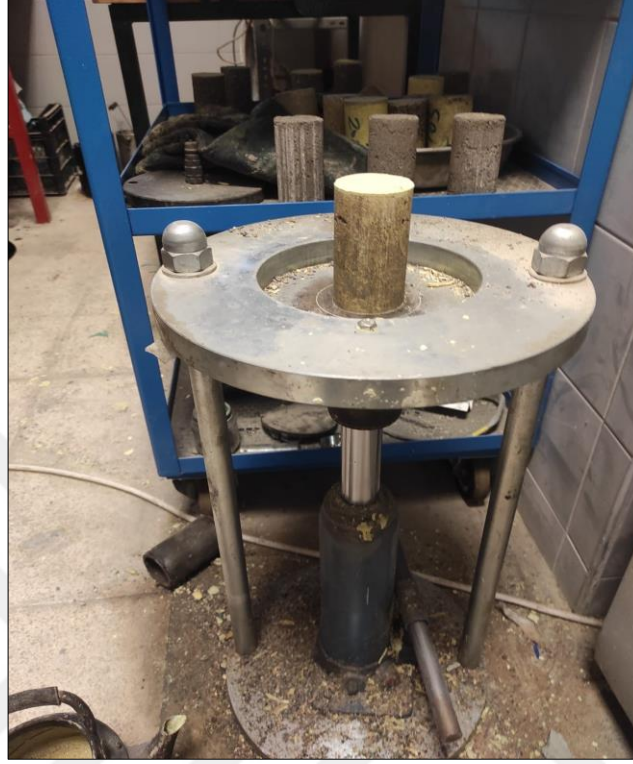
Şekil 5.24. Enjeksiyon uygulanmış numunelere kükürt başlık yapımı
