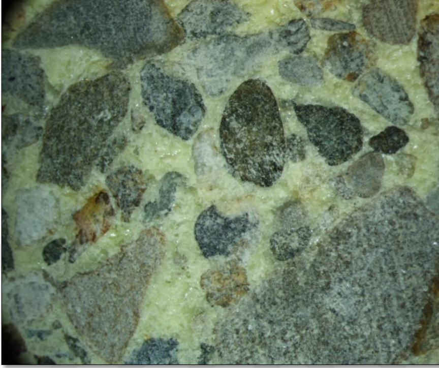
Şekil B.1. Başarılı enjekte olmuş GP numune örneğinin 40x fotoğrafı
