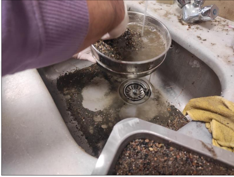
Şekil 5.19. Çalışmada kullanılan doğal zeminin yıkanması
