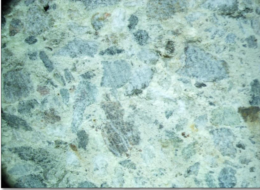
Şekil B.7. 100 kPa enjeksiyon basıncı uygulanmış SP numunenin 40x fotoğrafı
