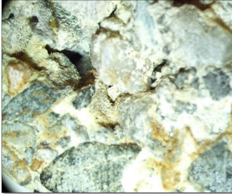
Şekil.B.4. Yetersiz enjeksiyon olmuş GP numunesi 40x fotoğrafı
