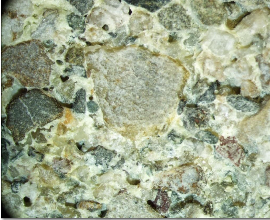
Şekil B.3. İçinde hava boşluğu kalmasından dolayı başarısız olmuş GP enjeksiyon numunesinin 40x fotoğrafı
