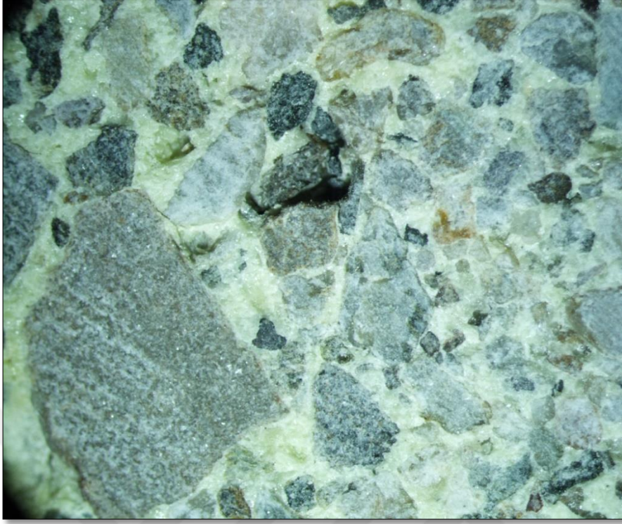
Şekil B.9. 600 kPa enjeksiyon basıncı uygulanmış SP numunenin 40x fotoğrafı
