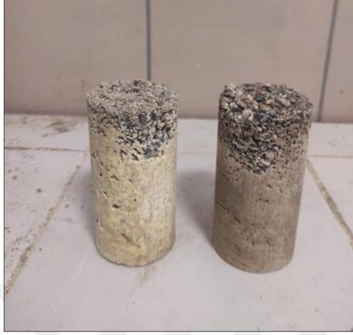
Şekil 5.22. Başarısız olmuş enjeksiyon numuneleri
