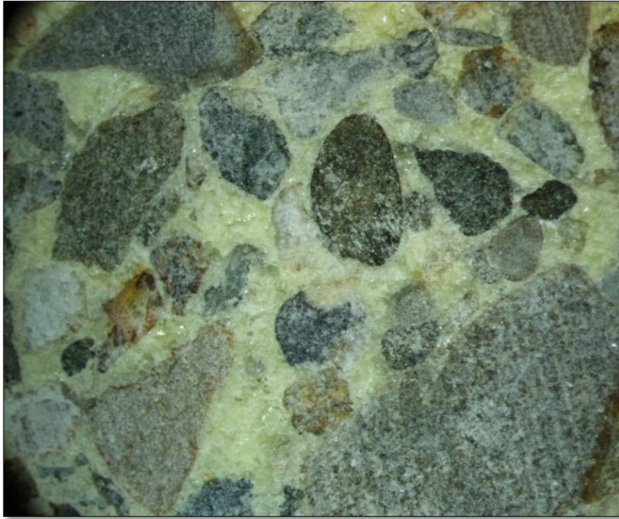
Şekil 6.1. Başarılı enjeksiyon olmuş numunenin 40x görüntüsü
