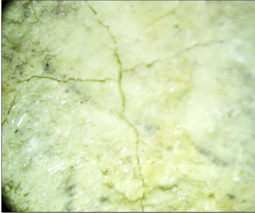
Şekil B.2. 28 günlük saf kükürt numunelerinde oluşan gerilme çatlaklarının 40x fotoğrafı
