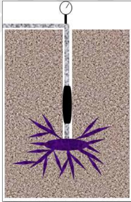
Şekil 3.7. Çatlatma enjeksiyonunun şematik gösterimi (Mutman, 2007)
