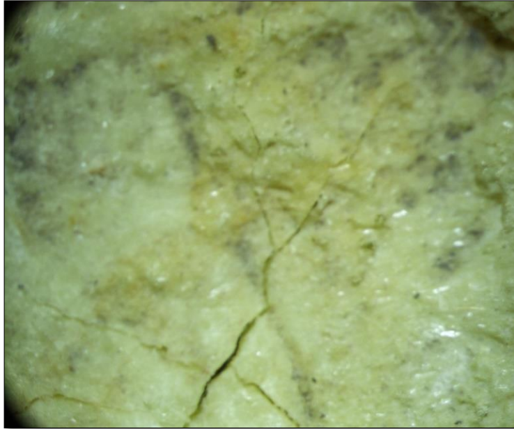
Şekil 6.10. 28 günlük numunelerde oluşan çatlaklar 40x büyütülmüş
