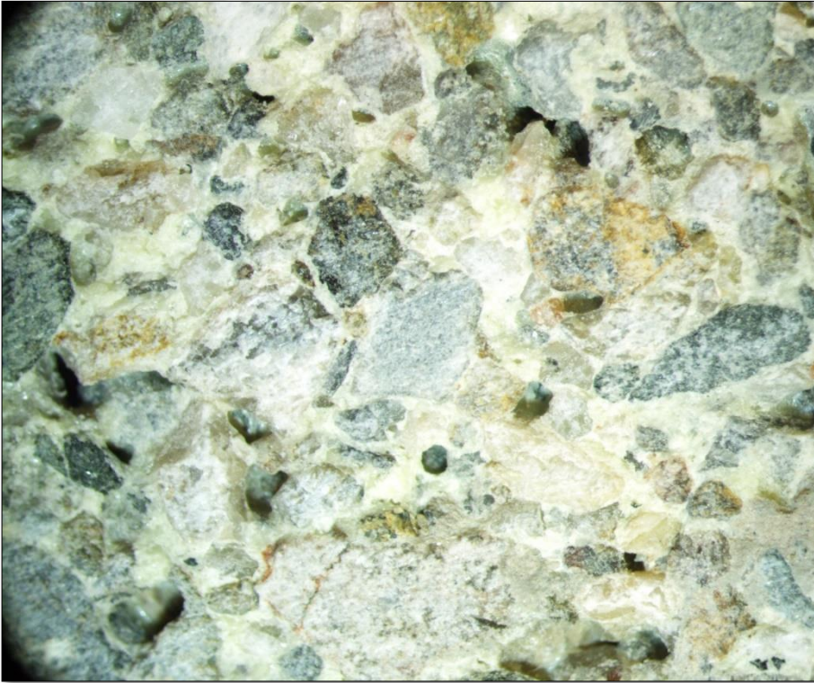
Şekil B.6. Başarısız enjeksiyon olmuş SP numunenin 40x fotoğrafı
