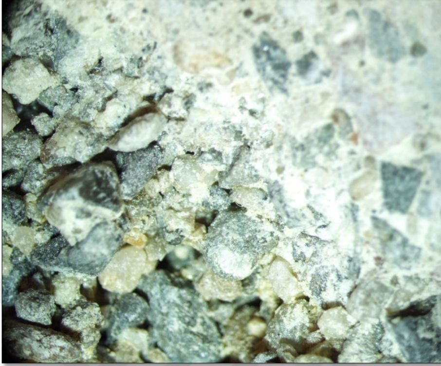
Şekil B.5. Yetersiz enjeksiyon olmuş SP numunesinin 40x fotoğrafı
