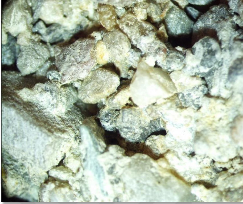
Şekil 6.2. Enjeksiyonu yetersiz olmuş numunenin 40x görüntüsü
