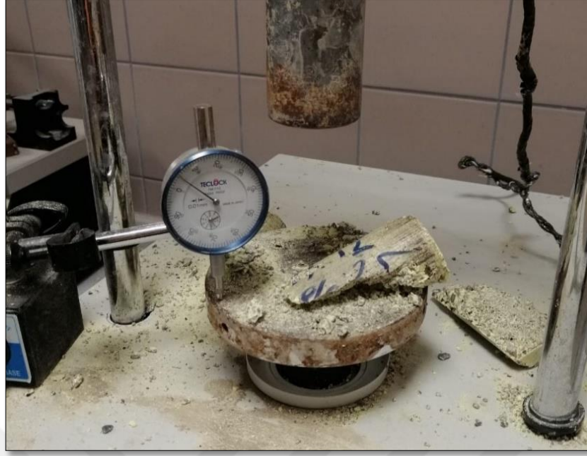
Şekil 6.7. Serbest basınç deneyi zemin numunesi kırılma paterni
