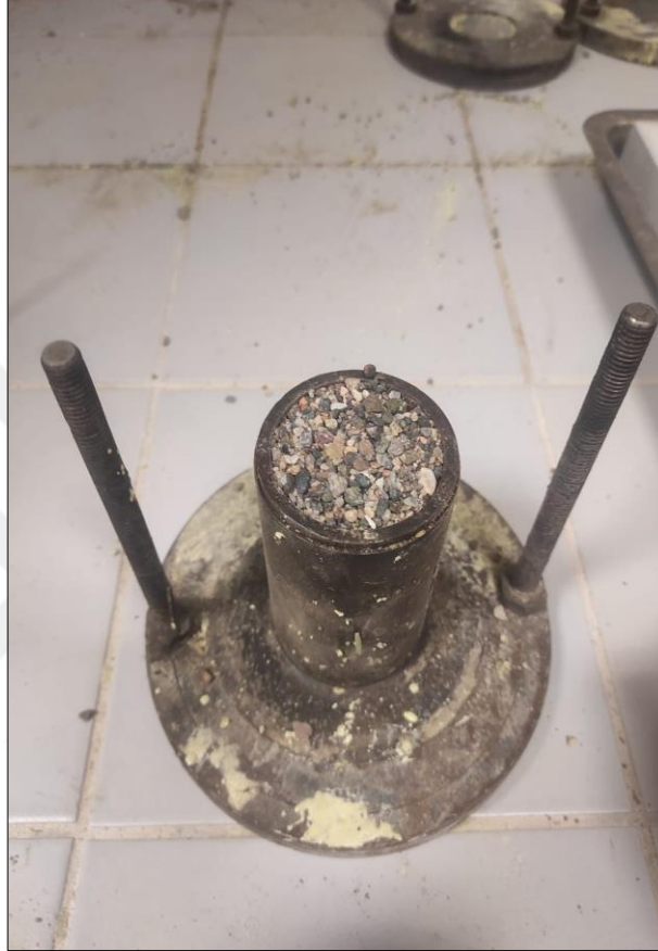
Şekil 5.21. Enjeksiyona hazır zemin numunesi
