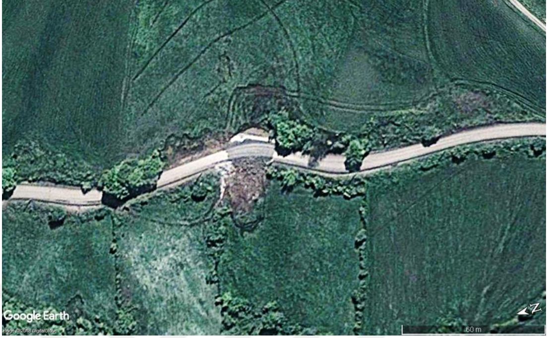
Şekil 5.6. Yol üzerinde tespit edilen rotasyonel kayma
