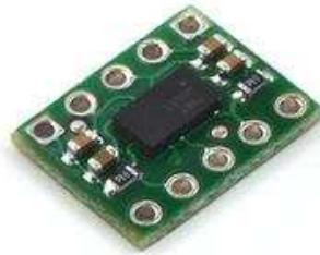
Şekil 2. 9: Esnek bağı robotta kullanılan ivmeölçer
