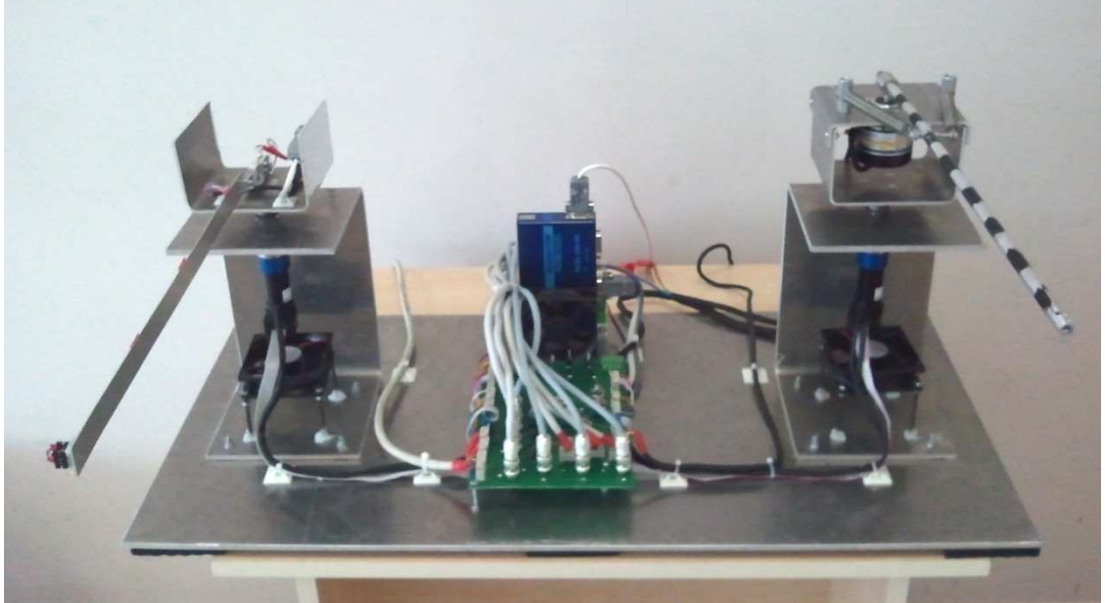
Şekil 2. 1 : Tek esnek bağı ve tek esnek eklemli robot kolu test düzeneği
