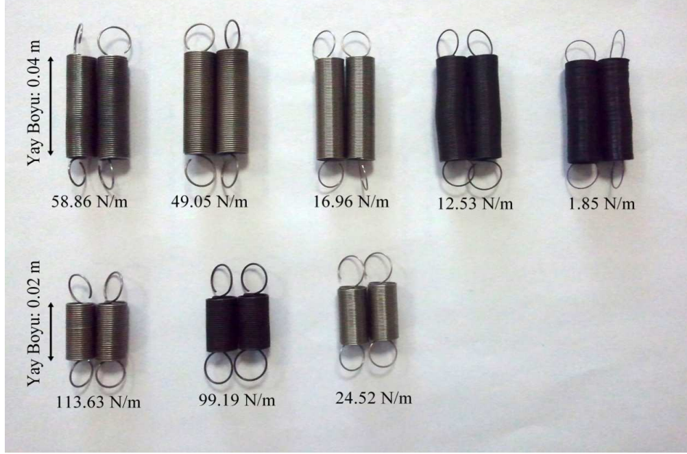
Şekil 3. 4: Kullanılan yaylar, yay boyları ve yay sertlikleri
