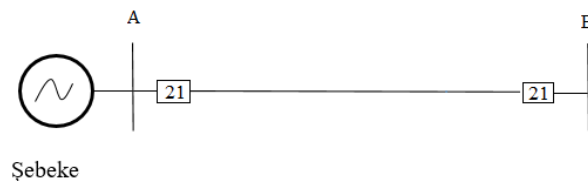
Şekil 3.18. Mesafe koruma rölesi transformatör merkezi yerleşimi
