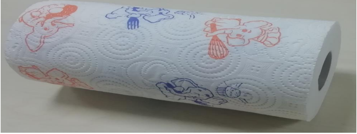
Şekil 3.11. Trim sonrası log halindeki ürün
