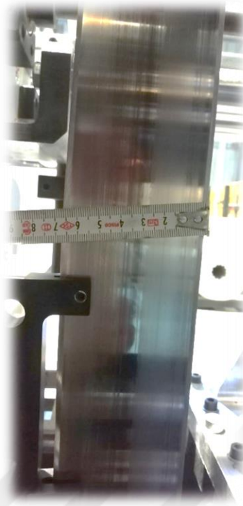
Şekil 6.27.Şerit genişliğinin 66.2 mm olduğunun gösterimi
