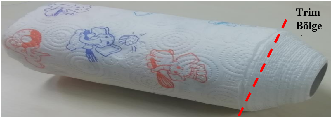
Şekil 3.10. Sargı makinesinde sarılan log halindeki ürüne ait form
