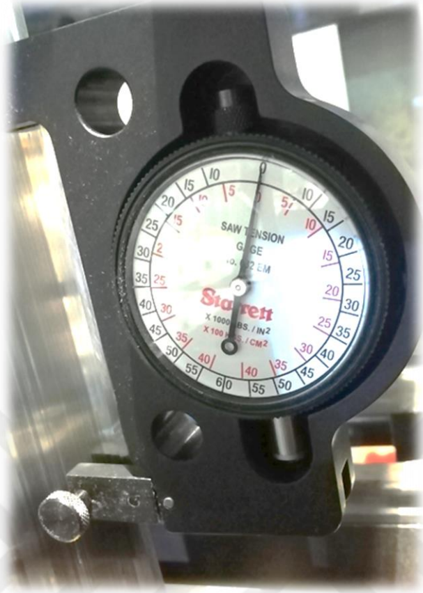
Şekil 6.25.Sistemin ağırlığı alındıktan sonra şerit üzerinde ölçülen gerilme
