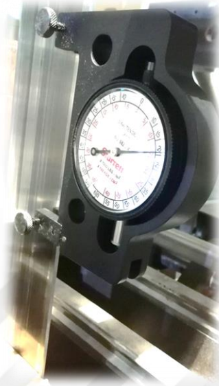
Şekil 6.29.Sisteme 70 bar basınç verildiğinde ölçülen gerginlik değeri
