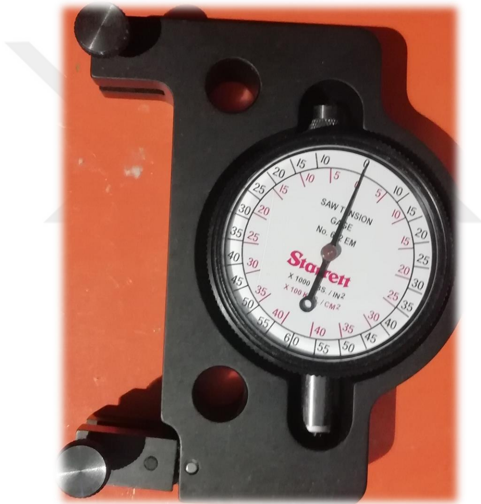
Şekil 6.19.Starrett Marke Gerginlik Ölçüm Cihazı
