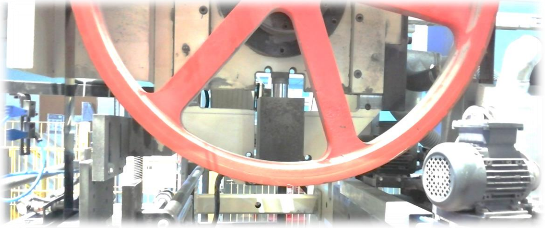
Şekil 6.26.Üst kasnağın yukarı doğru hareket etmesiyle gerilmeye başlayan şerit bıçak Şerit bıçağın kesit alanı genişliğiyle doğru orantılı olarak değişmektedir. Şerit bıçak bilindikçe genişliği azalmakta ve kesit alanı azalmaktadır. Şekil 6.27’de 66.2 mm olarak ölçülen şerit bıçağı gösterilmektedir.
