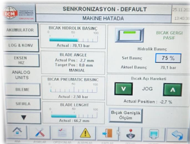
Şekil 6.28.Hidrolik Basınç Panel Üzerinde 70 Bara Ayarlanan Sistemi Gösteren Resim
