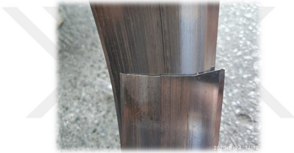
Şekil 6.2.Kopan şerit bıçağı örneği
