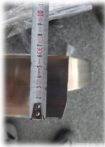
Şekil 6.3.Şerit genişliğinde meydana gelen azalma
