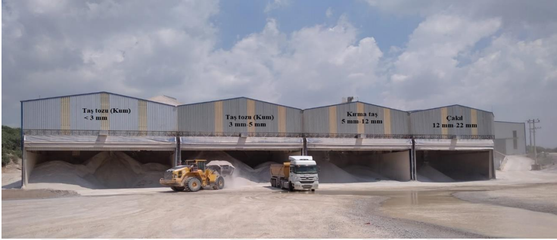
Şekil 4.1. Agregatasyon tesisinde kırma ve eleme işlemi sonrası
