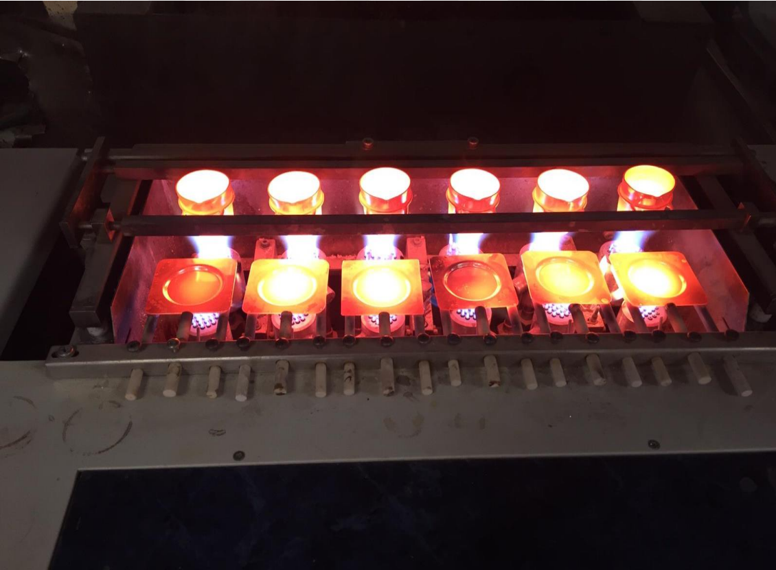
Şekil 5.10. Eritiş yapılması için kullanılan ocak
