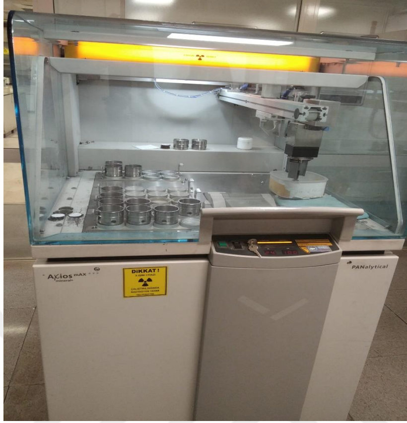
Şekil 5.13. Kimyasal değerleri belirlemek için kullanılan XRF cihazı
