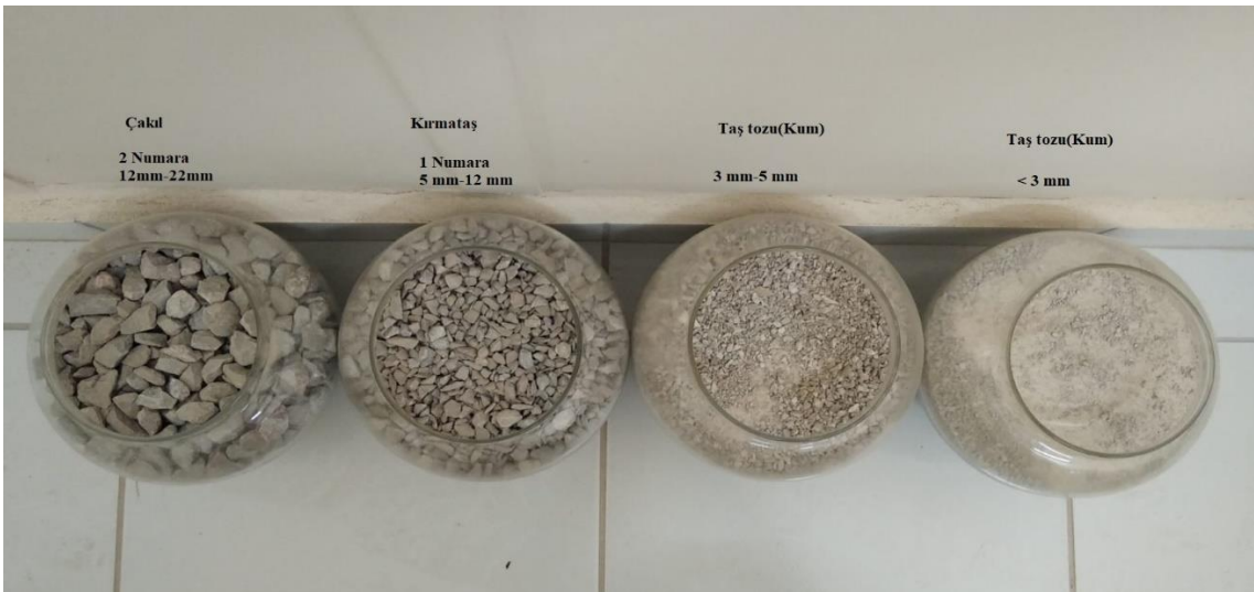
Şekil 4.2. Tane boylarına göre agrega sınıflaması
