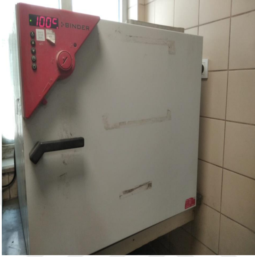
Şekil 5.7. Rutubet ölçmek için kullanılan etüv
