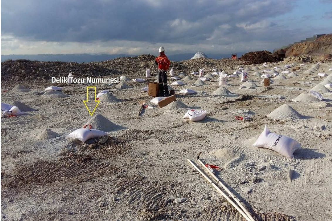
Şekil 5.4. Kaya delici makinesi ile çıkarılan delik tozu numunesi
