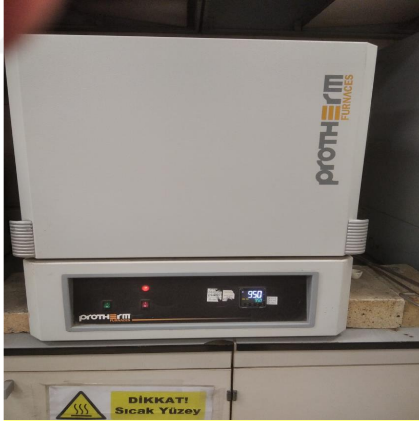
Şekil 5.6. Kızdırma kaybı ölçmek için kullanılan fırın
