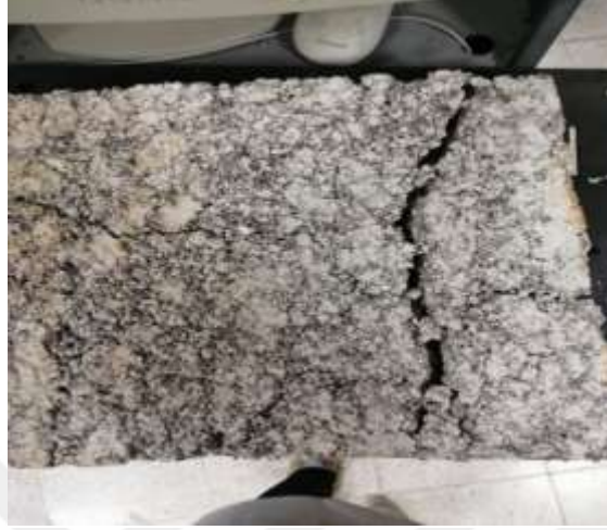
Şekil 5.12. Kalıptan çıkarken çatlayan numune
