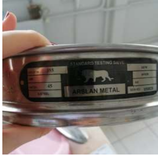
Şekil 4.3. Öğütme yapıldıktan sonra killeri elemek için kullanılan 355 mikron boyutundaki elek
