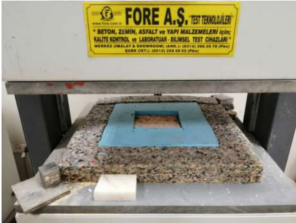
Şekil 5.12. Kalıptan çıkarken çatlayan numune
