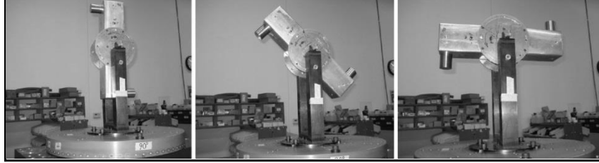
Şekil 2.10. Yunuslama-yandönme kardan yapısına sahip bir kardan mekanizmasının görseli [13]
