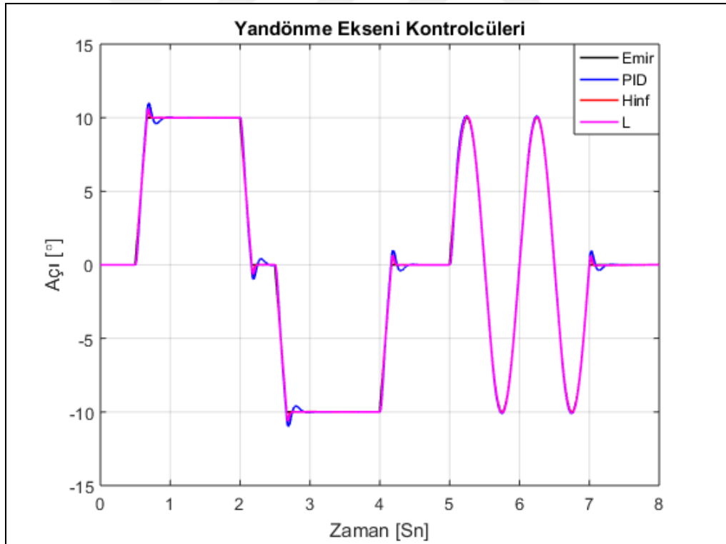
Şekil 5.53. Test emrine karşı kontrolcü çıktıları (yandönme eksenini)
