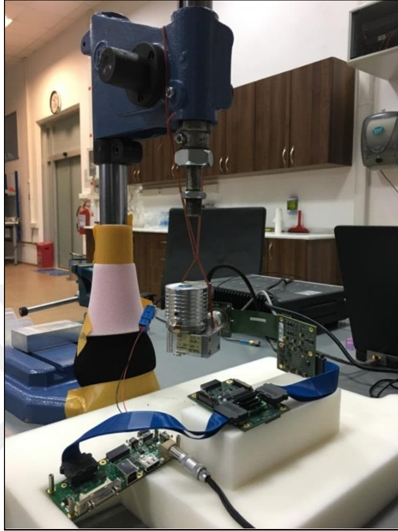
Şekil 3.33. Stirling soğutucu titreşimlerinin ölçümü
