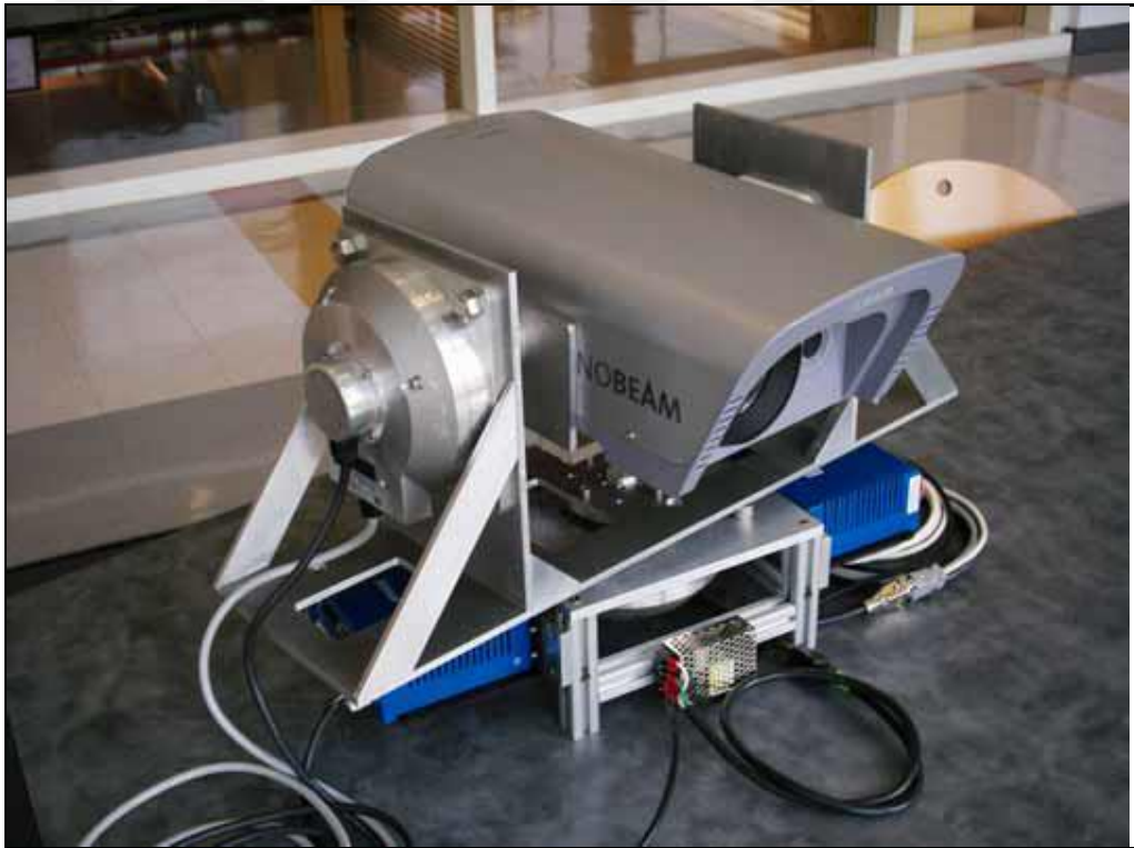
Şekil 2.1. Yandönme-yunuslama kardan yapısına sahip bir kardan mekanizmasının görseli [9]
