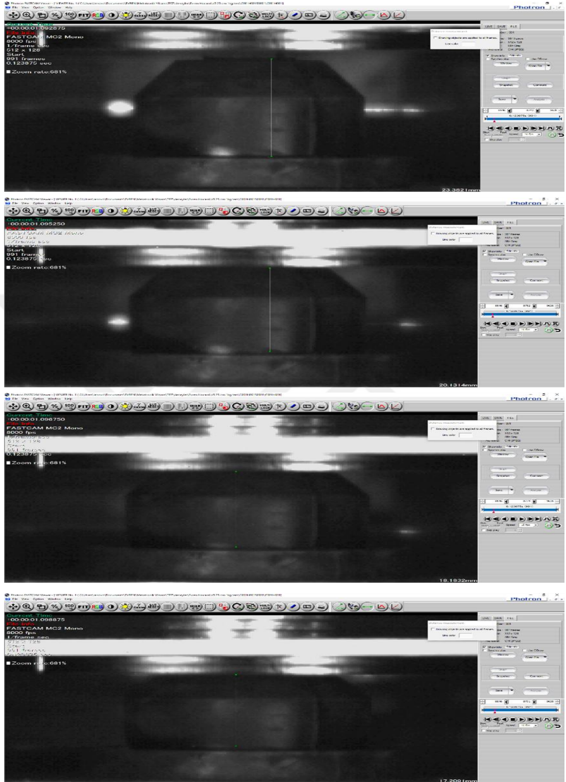
Şekil 2.1. 25 cm yükseklikten 1,0 kg kütleinin serbest düşmesi sonucu gerçekleşen darbe testi (Toplam 9,01 ms)
