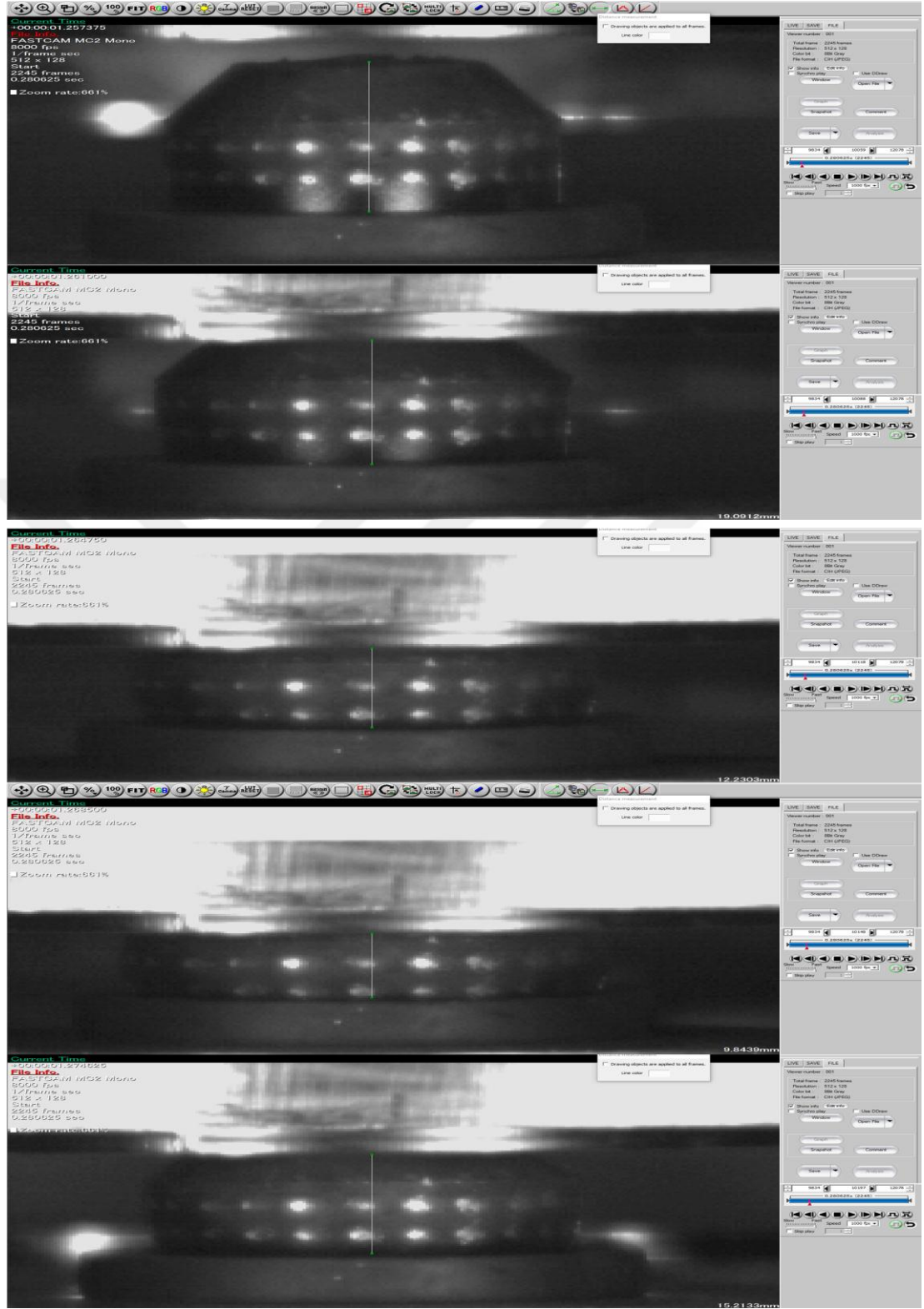
Şekil 2.4. 25 cm yükseklikten 10,0 kg kütleinin serbest düşmesi sonucu gerçekleşen darbe testi (Toplam 20,0 ms)
