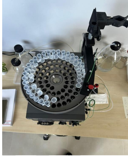
Şekil 3.3. AKTA Prime Plus Liquid Chromatography System. HiTrap Desalting kolonu ile saflaştırma işlemi.
