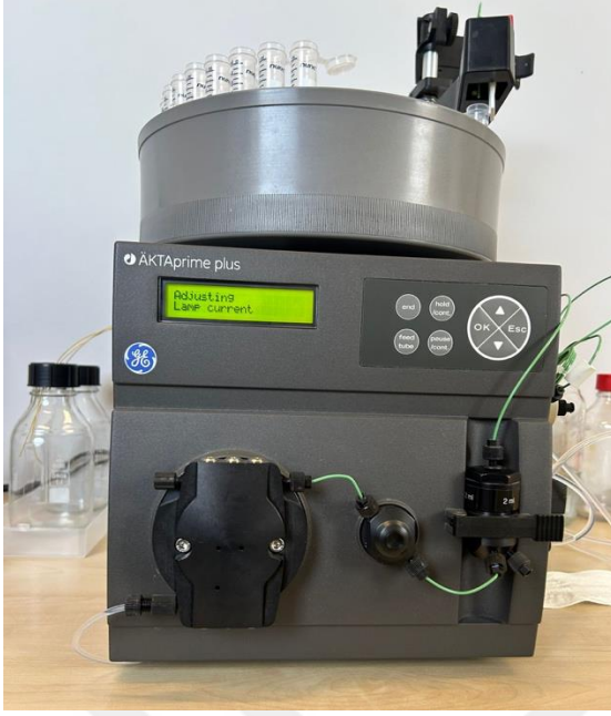
Şekil 3.3. AKTA Prime Plus Liquid Chromatography System. HiTrap Desalting kolonu ile saflaştırma işlemi.
