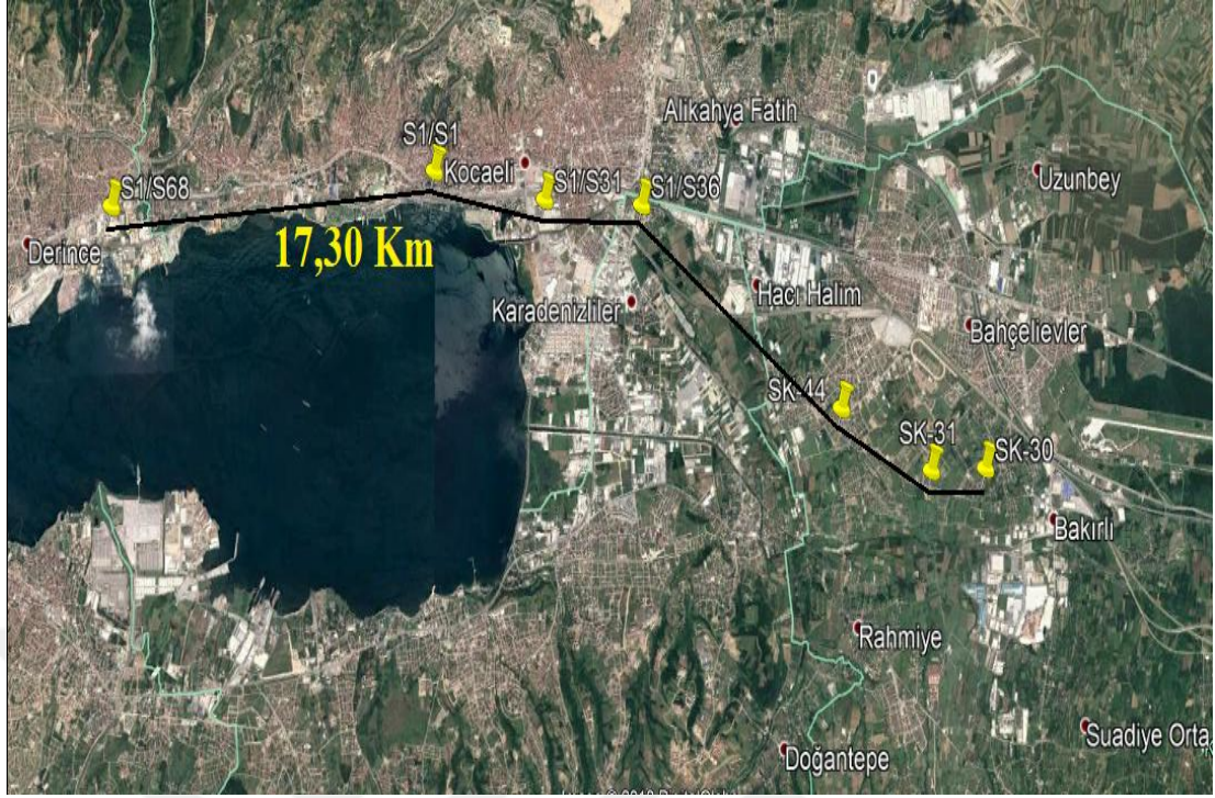
Şekil 5.3. İzmit-Köseköy bölgesi arasında zemin profili kesidi için kullanılan sondajlar
