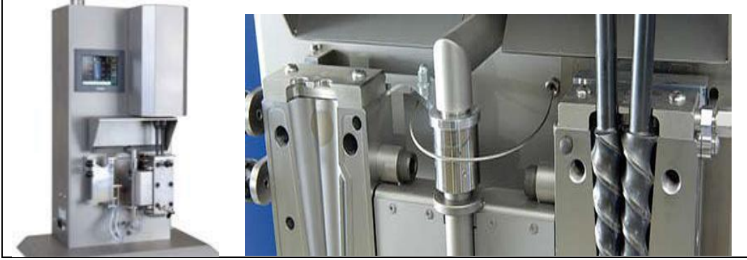
Şekil 2.4: DSM XPLORE marka ekstrüzyon cihazı
