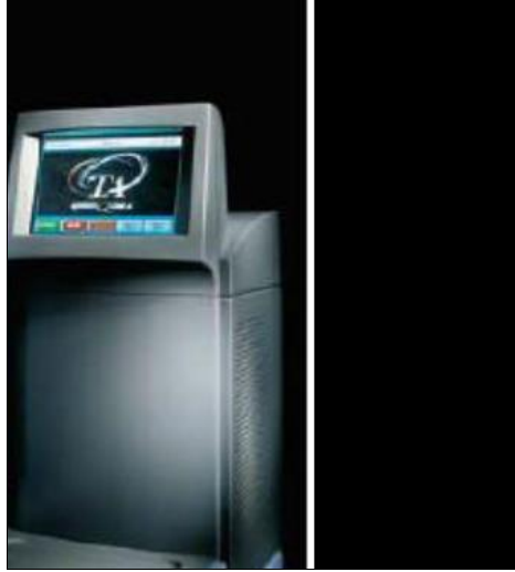
Şekil 2.14: Dinamik Mekanik Termal Analiz (DMTA Q800) cihazı
