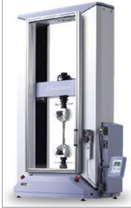
Şekil 2.8: Shimadzu marka universal çekme test cihazı
