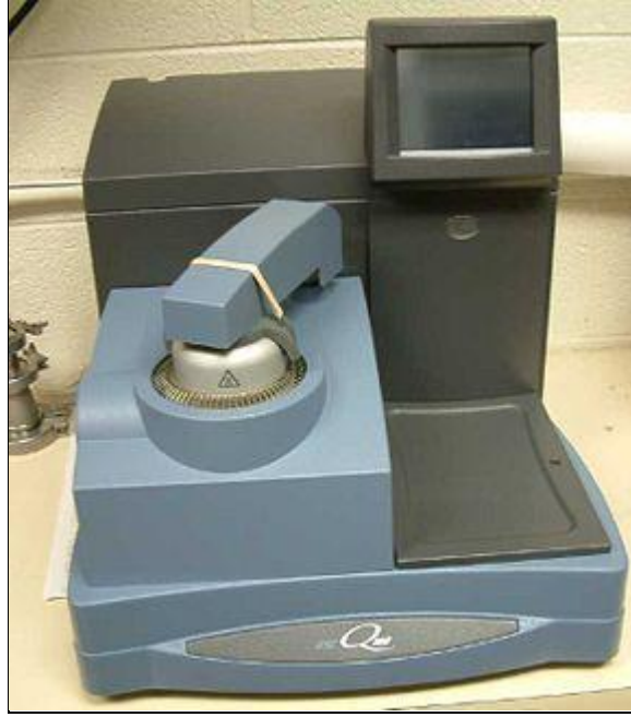
Şekil 2.9: TA Instruments Q-Series DTK (Q200) cihazı
