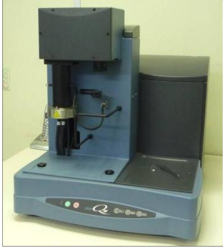
Şekil 2.10: TA Instruments Q-Series TGA (Q50) cihazı
