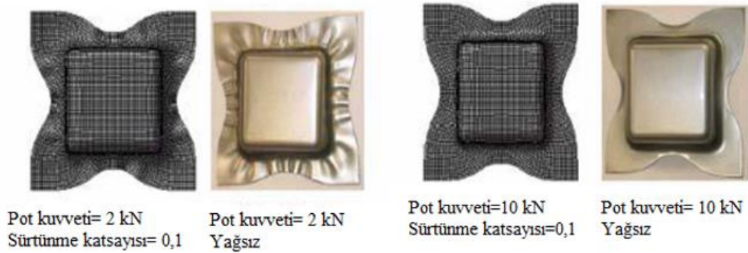
Şekil 2.7. Pot çemberi kuvvetinin kırışıklığa etkisi (Joshi ve diğ., 2013)
