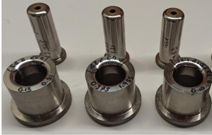
Şekil 6.21. Yüzey pürüzlülük ölçümü yapılmış kaplamasız kalıplar
