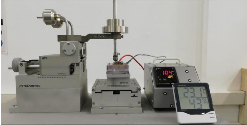
Şekil 5.11. Deneysel çalışmada kullanılan UTS marka reciprocating tipi tribometre
