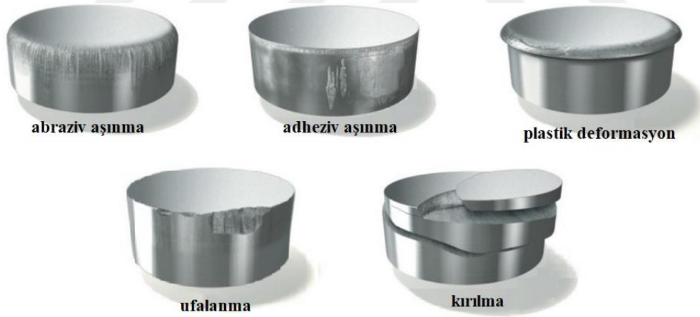
Şekil 4.1. Takım malzemelerinde gerçekleşen hasar mekanizmaları (Madorsky ve Thompson, 2005)
