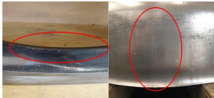
Şekil 4.2. Aşınmış kalıp ve parça görseli
