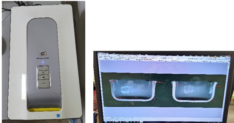
Şekil 5.14. Kalınlık ölçümü a) görüntü tarama cihazı b) program ekran görüntüsü
