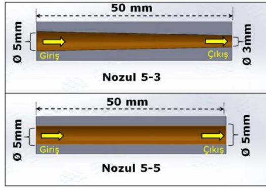
Şekil 2.62. Çalışmada kullandıkları nozulların geometri ve ölçüleri (Önen ve diğ., 2016)
