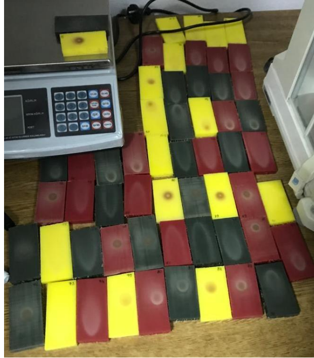
Şekil 5.6. Erozyon testlerine tabi tutulan kestamid polimer malzeme ve onun kompozitleri olan kestlub ve kestoil malzemelerin fotoğrafı
