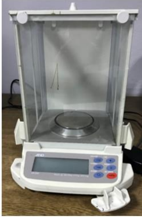
Şekil 5.5. Mevcut çalışmada kullanılan numunelerin ağırlık ölçümünün yapıldığı 0,1 mg hassasiyetteki elektronik terazi (Shimadzu Atx-224, Japan)
