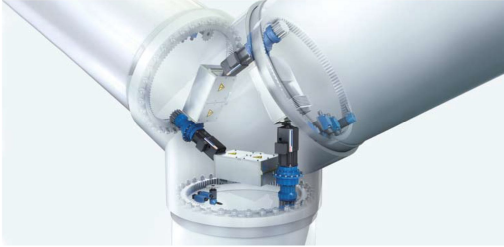
Şekil 7.1. Yunuslama motorlarının konumu ve göbek üzerine yerleştirilmesi
