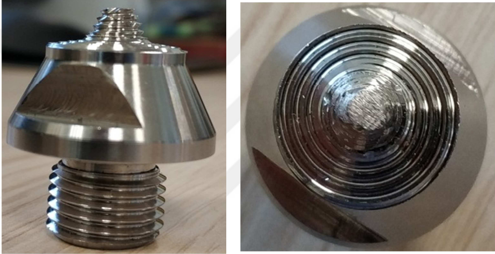
Şekil 4.1. Çalışmada kullanılan konik uçlu ve 3 yüzeyi düz kenarlı pim
