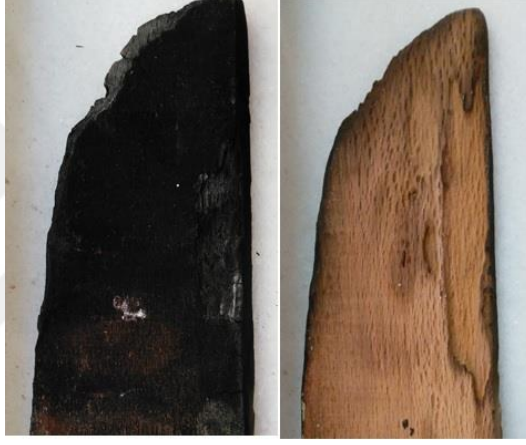
Şekil E.2. Karbonlaşmış tahta parçası
