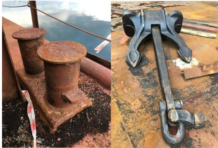
Şekil A.3. Aşınmış baba (halat sarmak için) ve demir çipa
