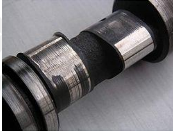
Şekil 1.1. Bir kam milinin adezyon aşınması
