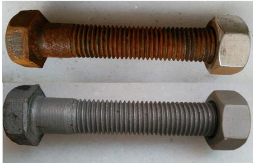
Şekil Ç.3. Temizlenmiş civata
