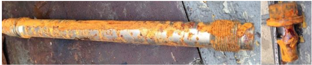
Şekil C.3. Aşınmış dişli civata ve somunu
