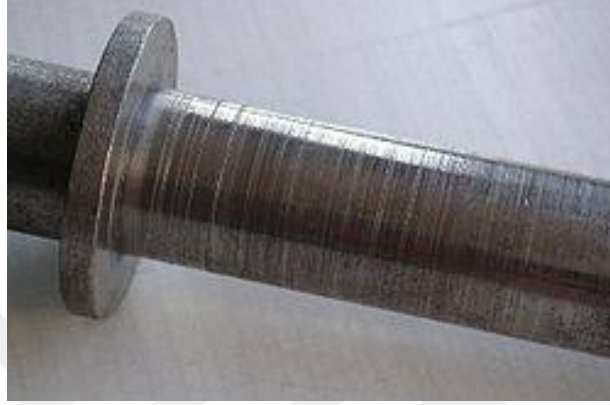
Şekil 1.2. Bir mil üzerindeki abrazyon aşınması
