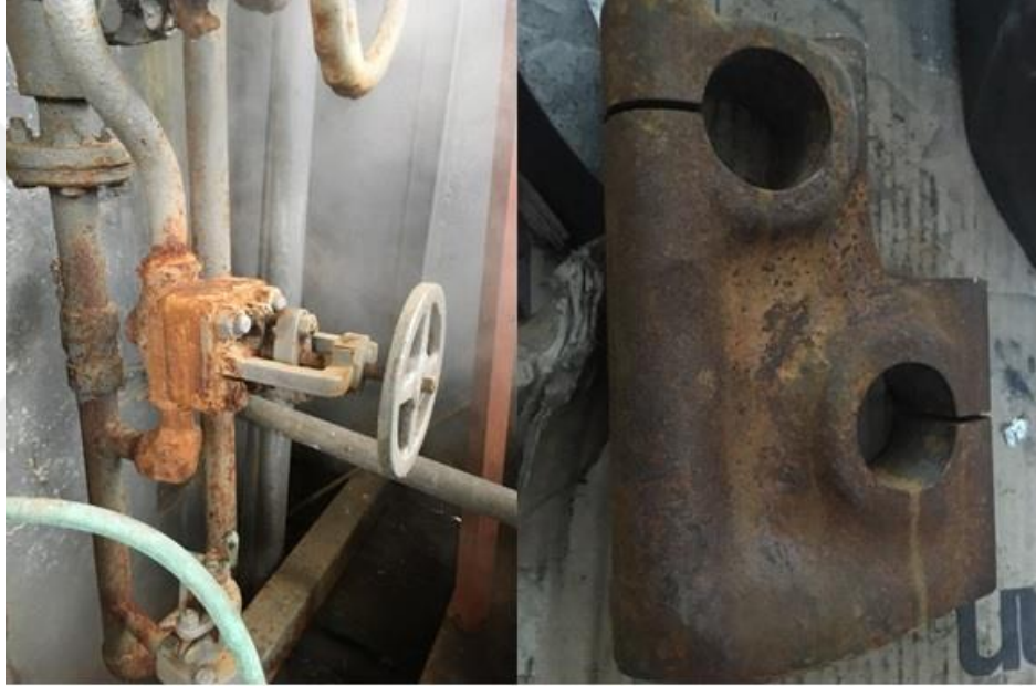
Şekil C.2. Aşınmış buharlı devre valfi ve rocker-arm parçası
