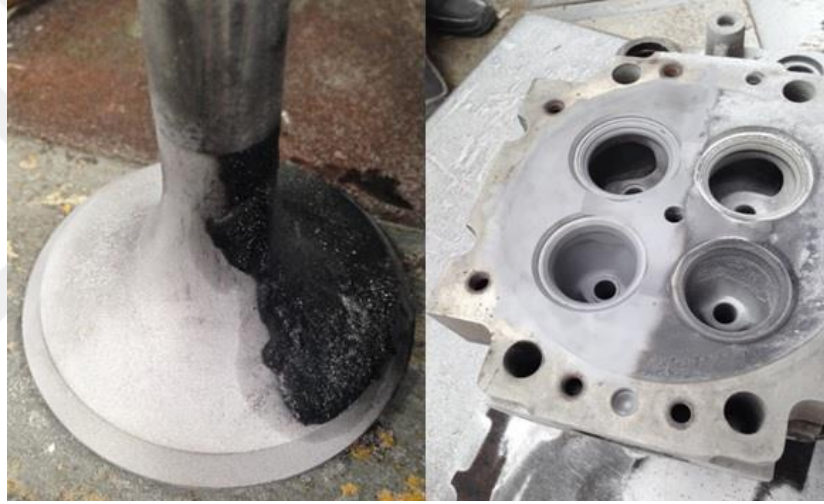
Şekil Ç.2. Temizlenmiş egzost manifoldu ve motor kaveri
