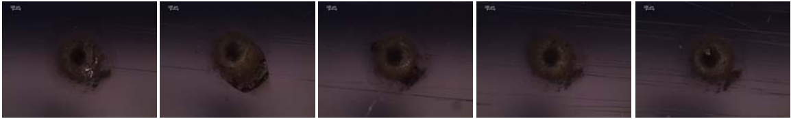
Şekil 26. Tablo 7 de verilen 14 numaralı deneyde elde edilen optik mikroskop görüntüleri. Polimer malzeme üzerine açılan deliğin üstten görüntüsü. Dalgaboyu: 1064 nm, enerji 15 mJ, frekans 9 Hz. Ortalama delik genişliği 238.73 \mu\text{m} olarak hesaplanmıştır.
