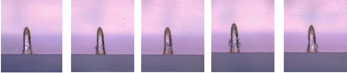
Şekil 7. Tablo 7 de verilen 7 numaralı deneyde elde edilen optik mikroskop görüntüleri. Polimer malzeme üzerine açılan deliğin kesit görüntüsü. Dalgaboyu: 355 nm, enerji 20 mJ, frekans 10 Hz. Ortalama delik derinliği 851.26 \mu\text{m} olarak hesaplanmıştır.
