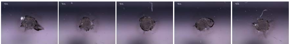
Şekil 21. Tablo 7 de verilen 9 numaralı deneyde elde edilen optik mikroskop görüntüleri. Polimer malzeme üzerine açılan deliğin üstten görüntüsü. Dalgaboyu 532 nm, enerji 10 mJ, frekans 9 Hz. Ortalama delik genişliği 254.98 \mu\text{m} olarak hesaplanmıştır.
