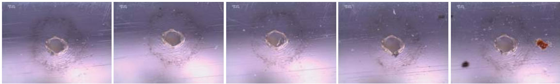
Şekil 20. Tablo 7 de verilen 8 numaralı deneyde elde edilen optik mikroskop görüntüleri. Polimer malzeme üzerine açılan deliğin üstten görüntüsü. Dalgaboyu: 355 nm, enerji 25 mJ, frekans 9 Hz. Ortalama delik genişliği 300.20 \mu\text{m} olarak hesaplanmıştır.
