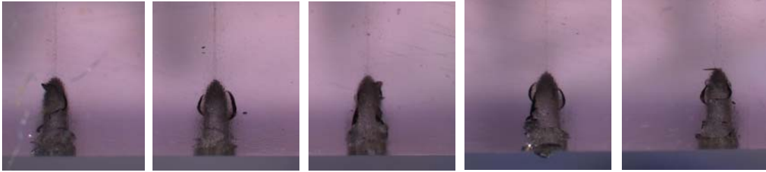
Şekil 11. Tablo 7 de verilen 11 numaralı deneyde elde edilen optik mikroskop görüntüleri. Polimer malzeme üzerine açılan deliğin kesit görüntüsü. Dalgaboyu: 532 nm, enerji 20 mJ, frekans 7 Hz. Ortalama delik derinliği 1075.2 \mu\text{m} olarak hesaplanmıştır.
