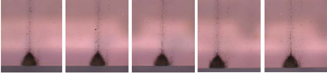
Şekil 13. Tablo 7 de verilen 13 numaralı deneyde elde edilen optik mikroskop görüntüleri. Polimer malzeme üzerine açılan deliğin kesit görüntüsü. Dalgaboyu: 1064 nm, enerji 10 mJ, frekans 10 Hz. Ortalama delik derinliği 417.07 \mu\text{m} olarak hesaplanmıştır.
