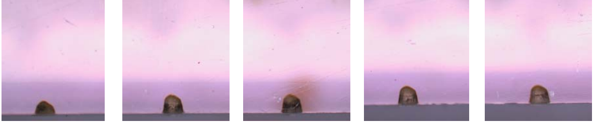
Şekil 5. Tablo 7 de verilen 5 numaralı deneyde elde edilen optik mikroskop görüntüleri. Polimer malzeme üzerine açılan deliğin kesit görüntüsü. Dalgaboyu: 355 nm, enerji 10 mJ, frekans 8 Hz. Ortalama delik derinliği 332.80 \mu\text{m} olarak hesaplanmıştır.
