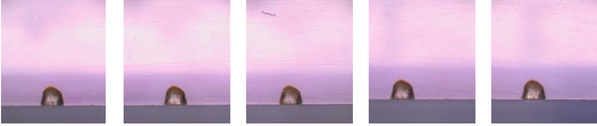
Şekil 6. Tablo 7 de verilen 6 numaralı deneyde elde edilen optik mikroskop görüntüleri. Polimer malzeme üzerine açılan deliğin kesit görüntüsü. Dalgaboyu: 355 nm, enerji 15 mJ, frekans 7 Hz. Ortalama delik derinliği 354.22 \mu\text{m} olarak hesaplanmıştır.
