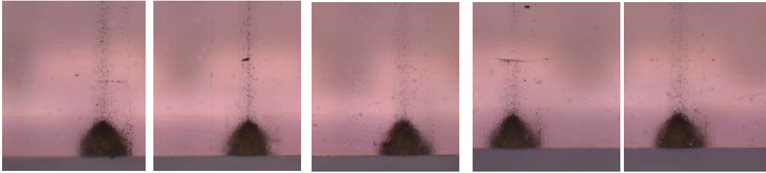
Şekil 15. Tablo 7 de verilen 15 numaralı deneyde elde edilen optik mikroskop görüntüleri. Polimer malzeme üzerine açılan deliğin kesit görüntüsü. Dalgaboyu: 1064 nm, enerji 20 mJ, frekans 8 Hz. Ortalama delik derinliği 484.27 \mu\text{m} olarak hesaplanmıştır.
