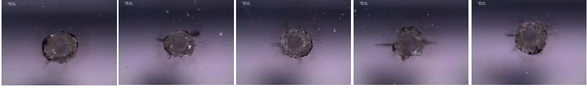
Şekil 22. Tablo 7 de verilen 10 numaralı deneyde elde edilen optik mikroskop görüntüleri. Polimer malzeme üzerine açılan deliğin üstten görüntüsü. Dalgaboyu: 532 nm, enerji 15 mJ, frekans 10 Hz. Ortalama delik genişliği 265.82 \mu\text{m} olarak hesaplanmıştır.
