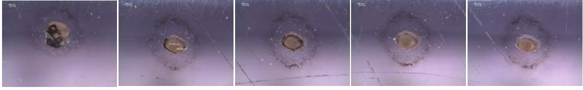
Şekil 17. Tablo 7 de verilen 5 numaralı deneyde elde edilen optik mikroskop görüntüleri. Polimer malzeme üzerine açılan deliğin üstten görüntüsü. Dalgaboyu: 355 nm, enerji 10 mJ, frekans 8 Hz. Ortalama delik çapı 307.65 \mu\text{m} olarak hesaplanmıştır.
