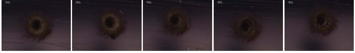
Şekil 27. Tablo 7 de verilen 15 numaralı deneyde elde edilen optik mikroskop görüntüleri. Polimer malzeme üzerine açılan deliğin üstten görüntüsü. Dalgaboyu: 1064 nm, enerji 20 mJ, frekans 8 Hz. Ortalama delik genişliği 322.03 \mu\text{m} olarak hesaplanmıştır.
