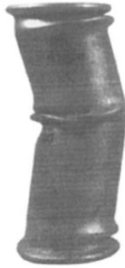
Şekil 3.24. Eksenel Olarak Ezilmiş Köpük Dolgulu Dairesel Borularda Küresel Bükülme (Seitzberger ve diğ., 1997)
