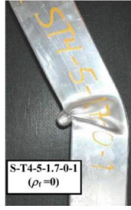
Şekil 3.14. 5° Açılı Eğik Yüklemeye Tabi Tutulan Kare Alüminyum Borunun Deformasyon Modu (Baroutaji ve diğ., 2017)
