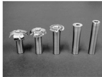
Şekil 3.6. Yumuşak Çelik Numunelerde Mantarlaşma Deformasyonu: Sırasıyla 385 m/s, 277 m/s, 173 m/s ve 0 m/s Hızlarda Deformasyon Durumları (Baroutaji ve diğ., 2017)
