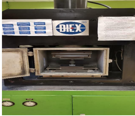
Şekil 4.8. Sinterleme cihazına yerleştirilmiş kalıbın görüntüsü
