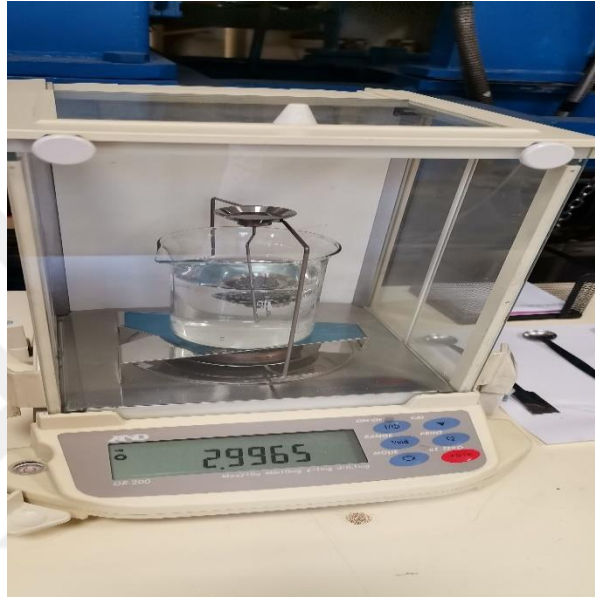
Şekil 4.10. Arşimet terazisi ile yoğunluk tespiti
