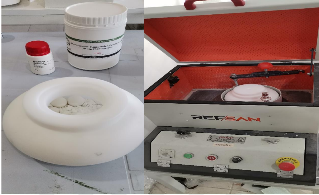
Şekil 4.5. Hazırlanan karışımların jet değirmen ile karıştırılması
