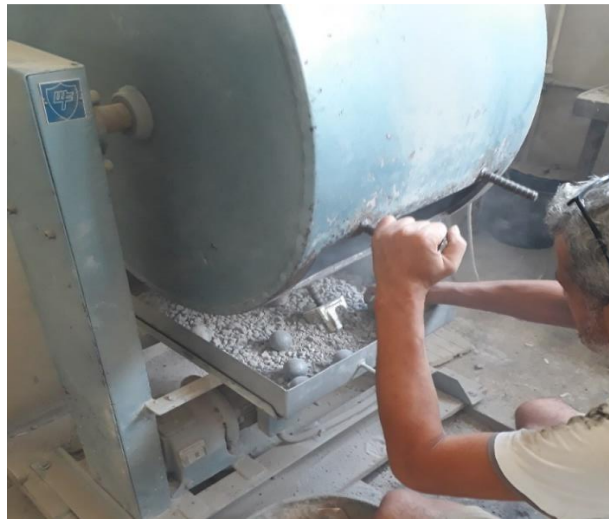
Şekil 5. 10. Los Angeles deneyinin uygulanaşı
