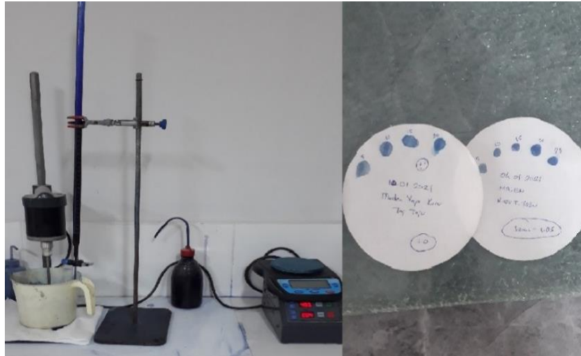
Şekil 5. 7. Metilen mavisi deneyi ve deneye ait leke kartları
