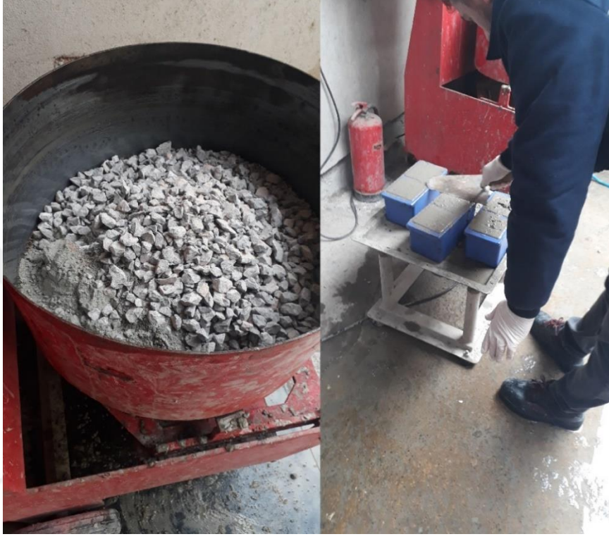
Şekil 5. 30. Beton numunelerinin hazırlanması
