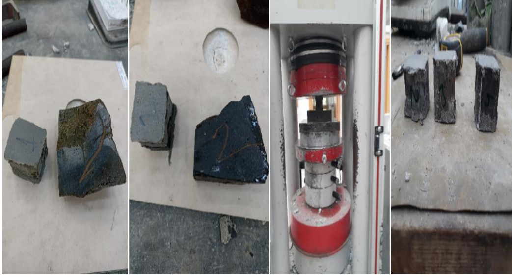
Şekil 5. 13. Tek eksenli basınç dayanımı deneyinin uygulanaşı
