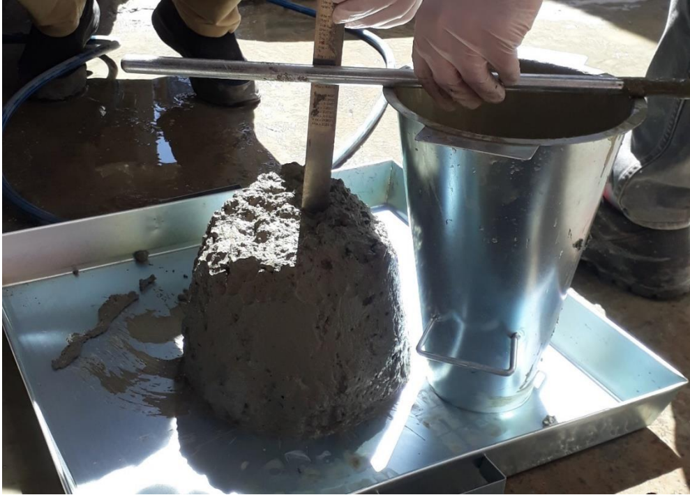
Şekil 5. 27. Taze betonda çökme deneyinin uygulanışı
