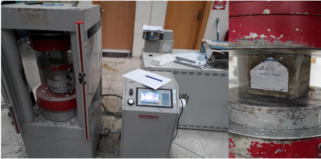
Şekil 5. 32. Üretilen deneme betonlarda basınç dayanımı deneyinin uygulaması
