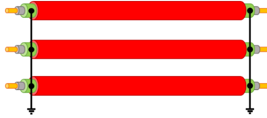
Şekil 4.3. İki uçtan topraklama bağlantı şeması
