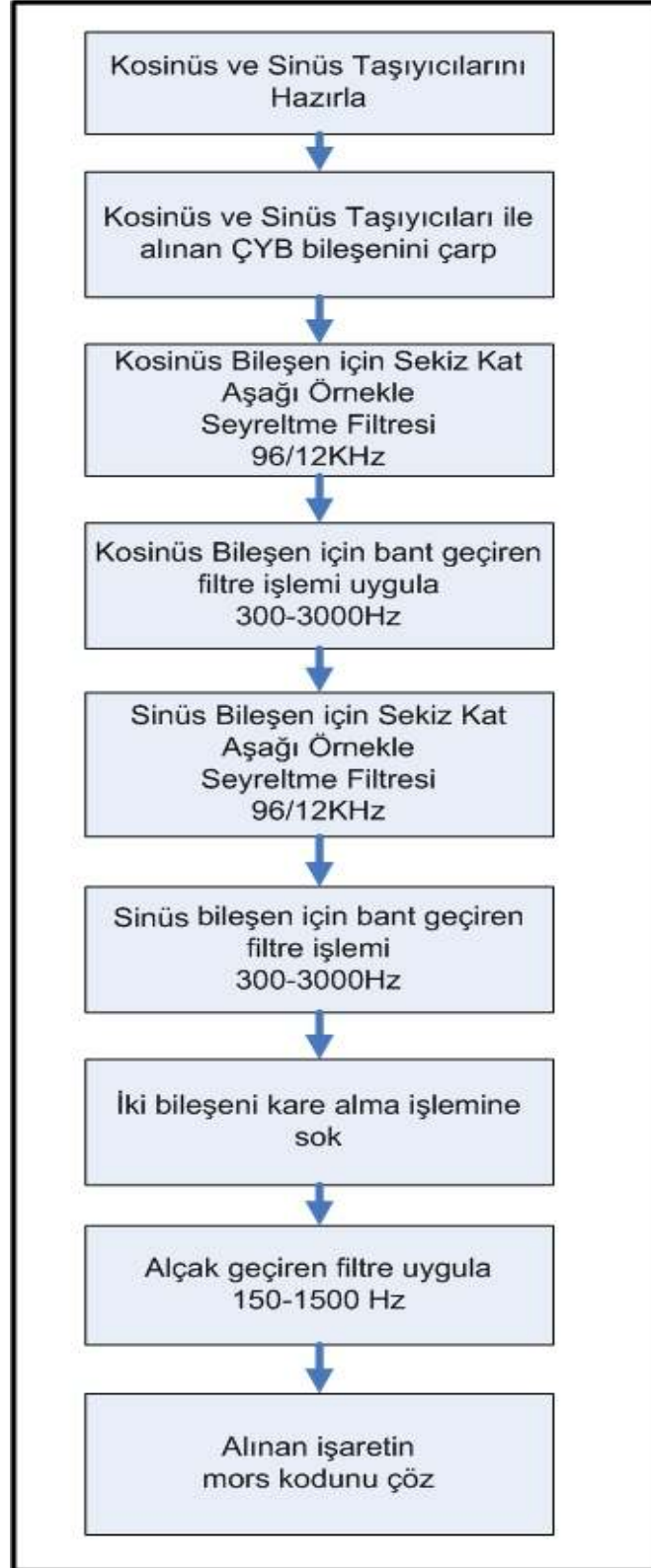
Şekil 3.17: Zarf detektörlü genlik demodülasyonu algoritması
