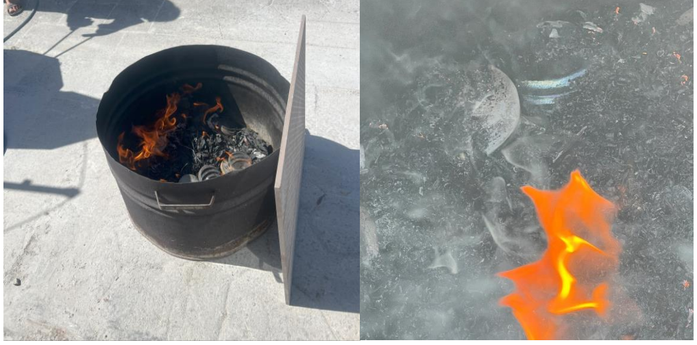
Görsel 13: Metal Varil İçine Yerleştirilen Deneme Tabletleri
