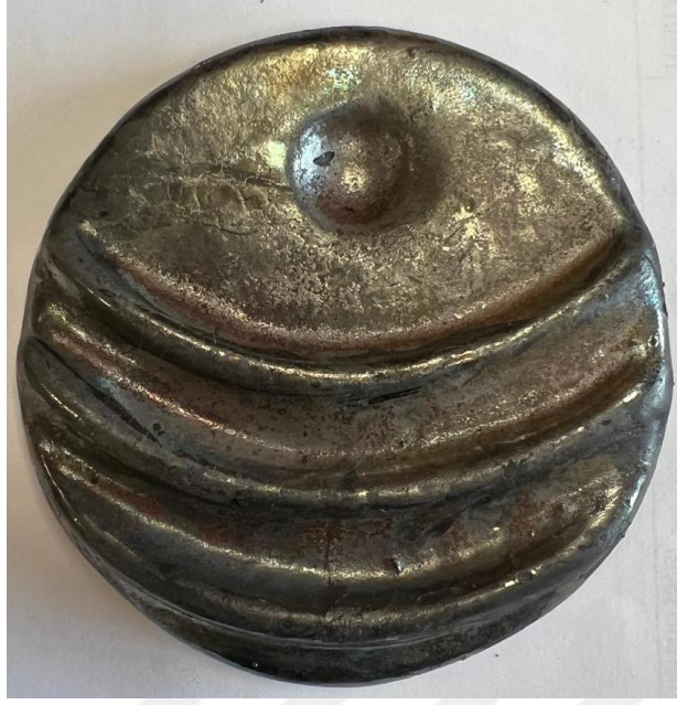
Görsel 45: 1RB2 Kodlu Sır - %2 AgNO 3 Beyaz Çamur Bünye-Redüksiyon
