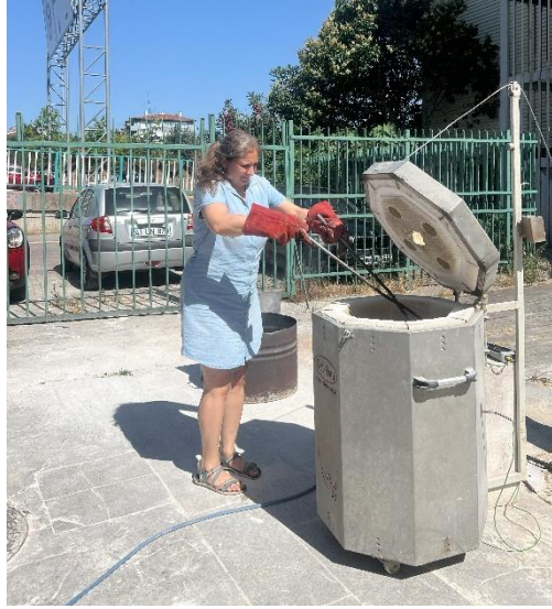
Görsel 12: Deneme Tabletlerinin Fırının İçinden Metal Maşayla Alınması İşlemi
