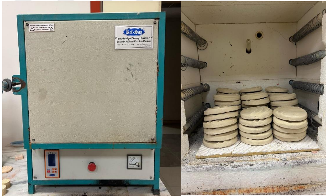
Görsel 10: Çalışmada Kullanılan Elektrikli Kamara Fırının Dışı Ve İçi
