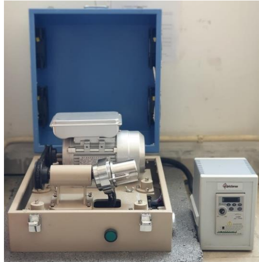
Şekil 3.4. Optosense marka laboratuvar tipi bilyalı değirmen
