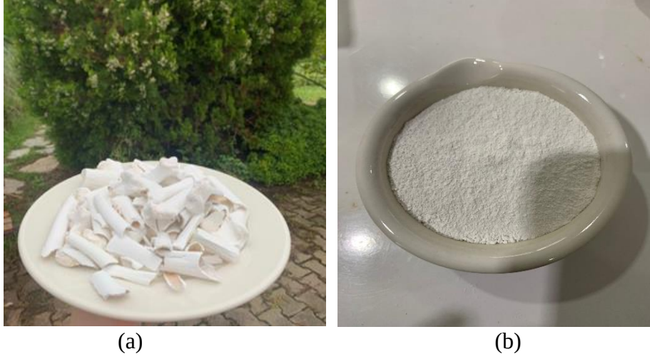
Şekil 3.3. (a) kalsinasyon işleminden sonra kemiklerin görüntüsü, (b) KHA kütlelerinin kaba öğütülmesi.
