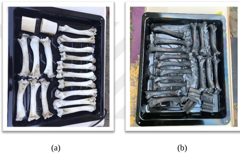
Şekil 3.2. (a) Temizlenmiş koyun kemiklerinin ön kalsinasyon işleminden önceki görüntüsü, (b) Temizlenmiş koyun kemiklerinin ön kalsinasyon işleminden sonraki görüntüsü
