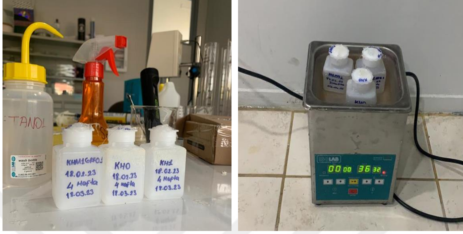
Şekil 3.11. Yapay vücut sıvısı içerisinde tutulan numunelerin düzeneđi.
