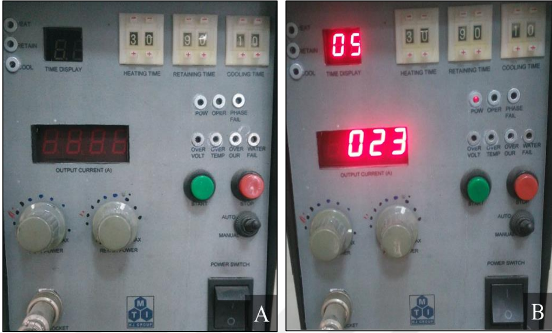
Şekil 3.7. (A) Sinterleme işleminin ön ısıtma kademesi için uygulanan ayarlar, (B) Sinterleme işleminin tamamlanması için uygulanan ayarlar
