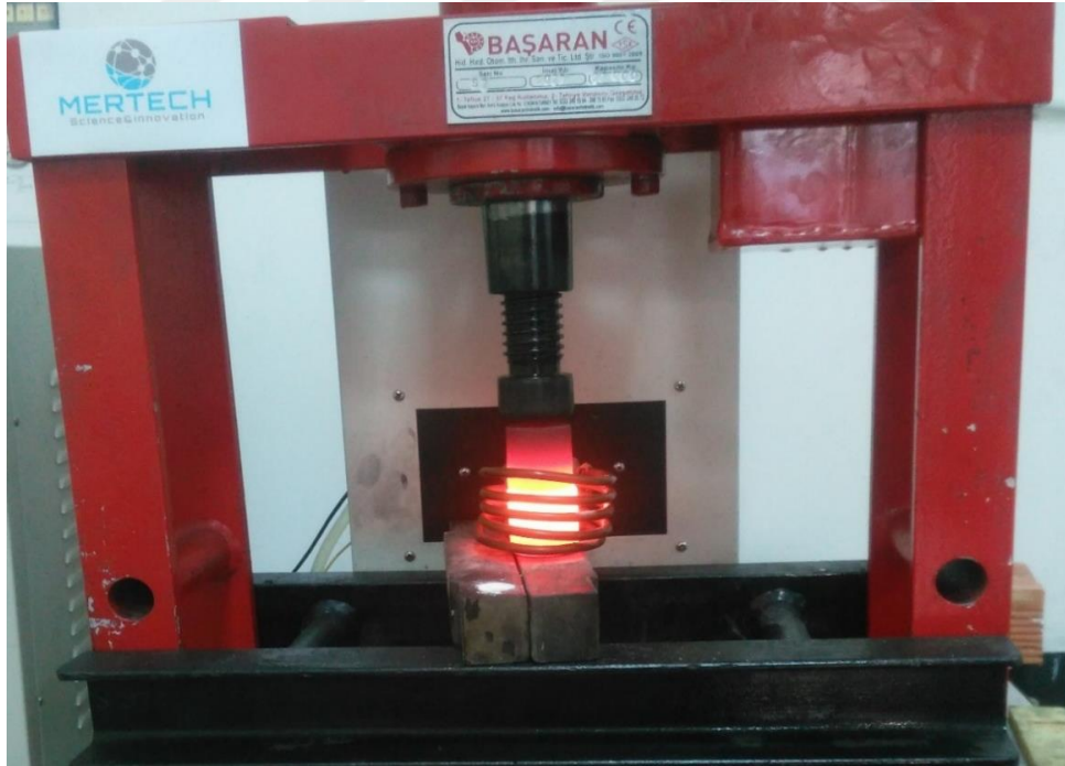
Şekil 3.8. Mertech marka olan sinterleme cihazı ile sinterleme işleminin gerçekleştirilmesi.
