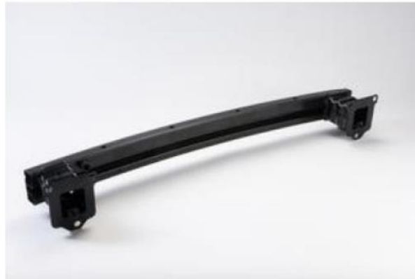
Şekil 3.24. Kalınlığı 1,35 mm olan DP1180 çeliğinin tamponda uygulanması (Köse, 2015)
