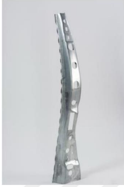
Şekil 3.25. DP980 çeliğinin B sütunu desteğinde uygulaması (Köse, 2015)
