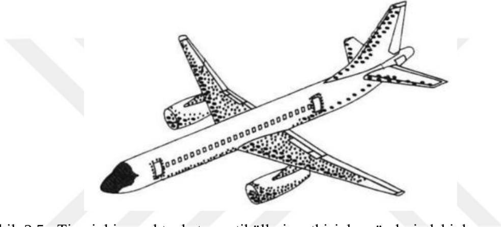
Şekil 2.5. Ticari bir uçakta katı partiküllerin etkisiyle gövdesindeki hasar oranının dağılımı (Gohardani, 2011)
