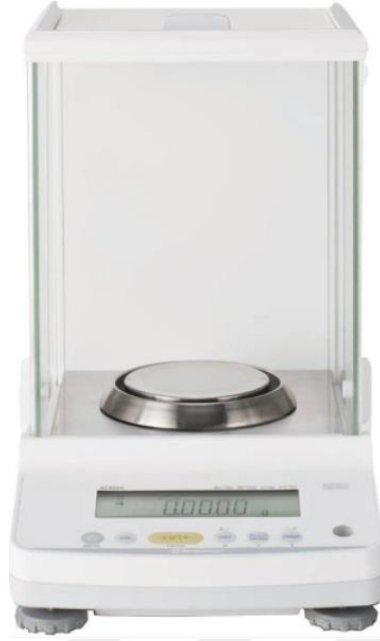
Şekil 6.1. Deneylerde kullanılan 0,1 mg hassasiyetteki elektronik terazi (Shimadzu Atx-224, Japan) ( https://www.cihazmarketi.com/urun/shimadzu-atx224-analitik-terazi )
