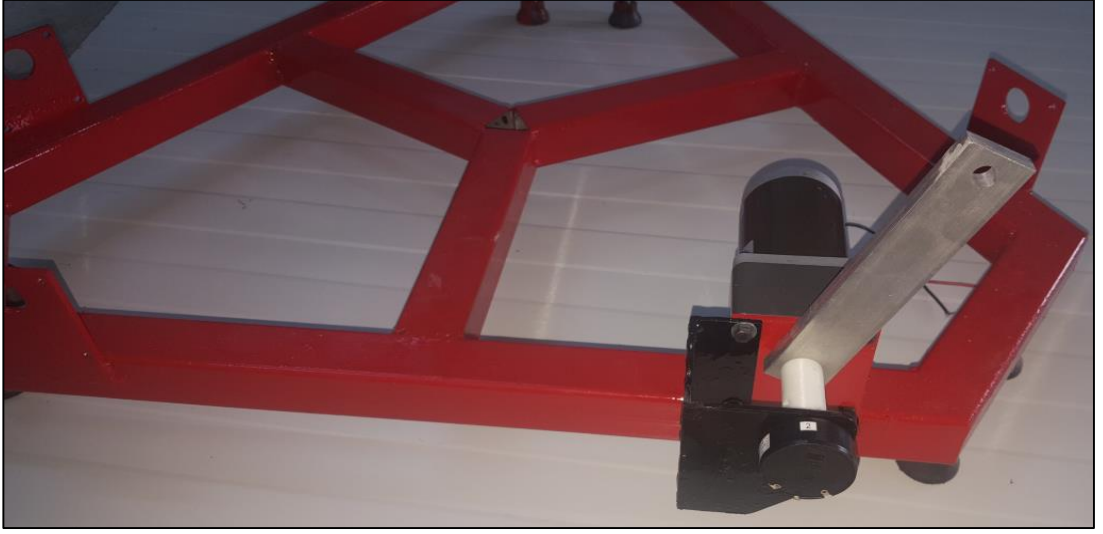
Şekil 5.2. DC motor montajı
