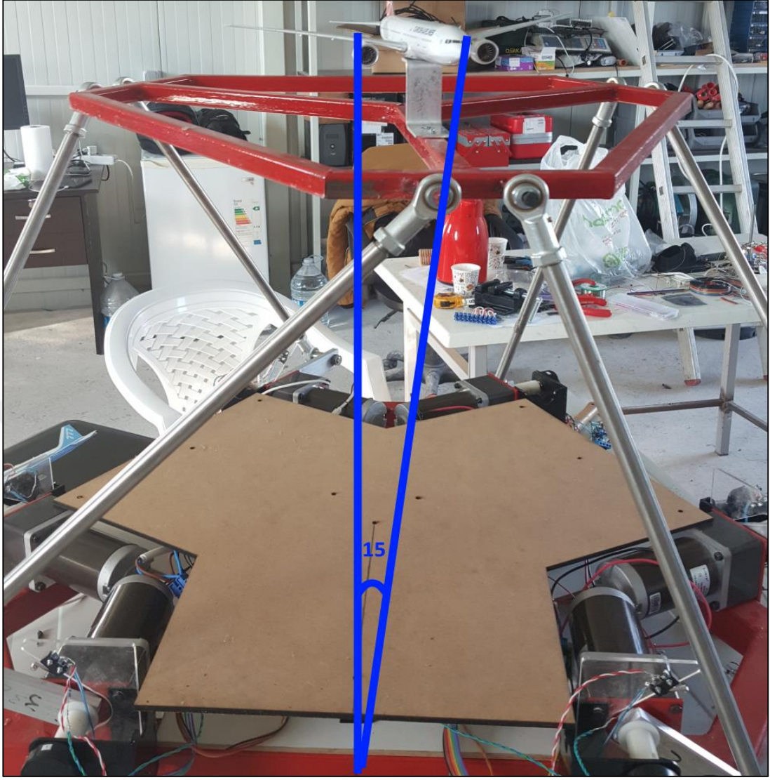
Şekil 6.3. Platform yaw hareketi önden görünüş
