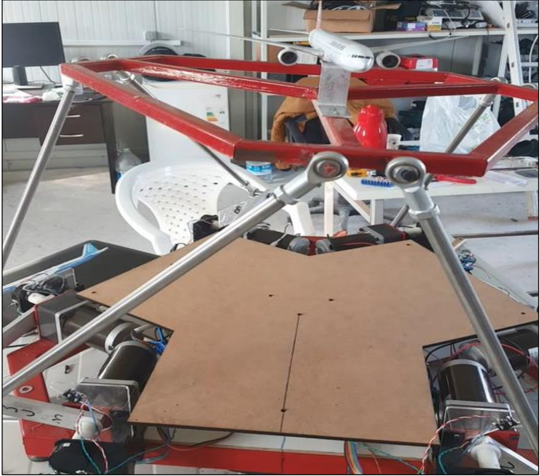
Şekil 6.14. Platformun yatış, dalış ve sapma hareketlerini birlikte yapması
