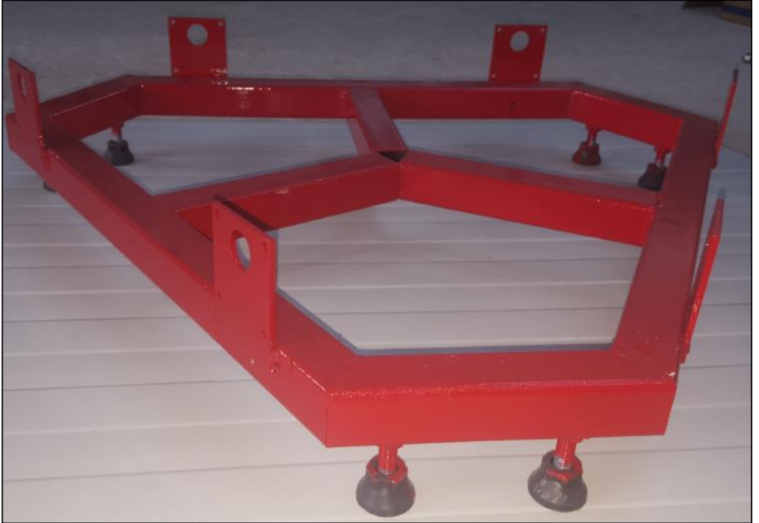
Şekil A.2. Üretilen alt tablanın yandan görünüşü
