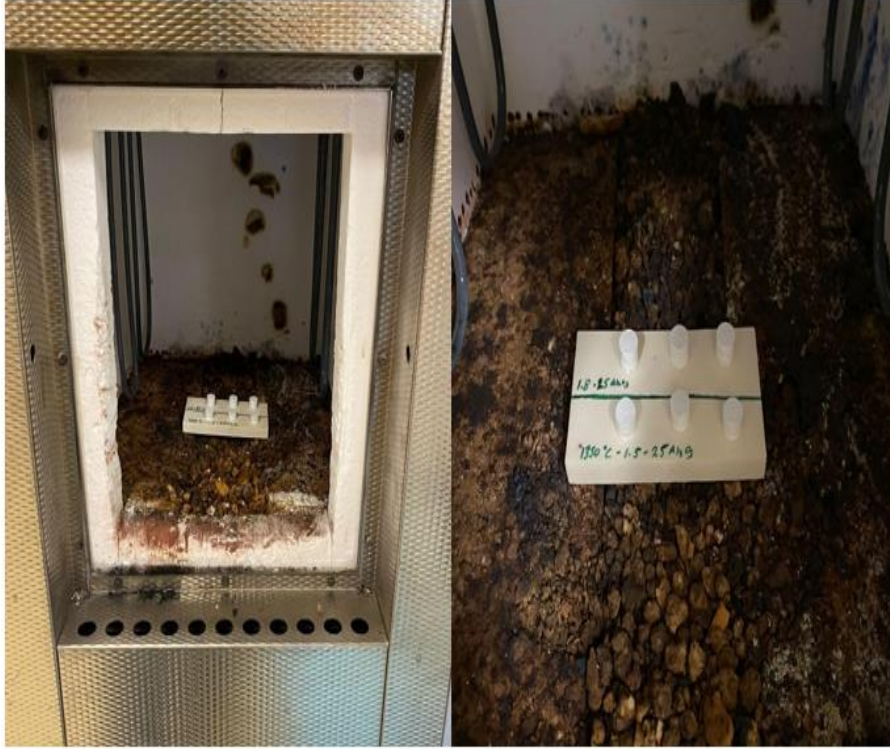
Şekil 6.5. Numunelerin sinterleme süreçleri
