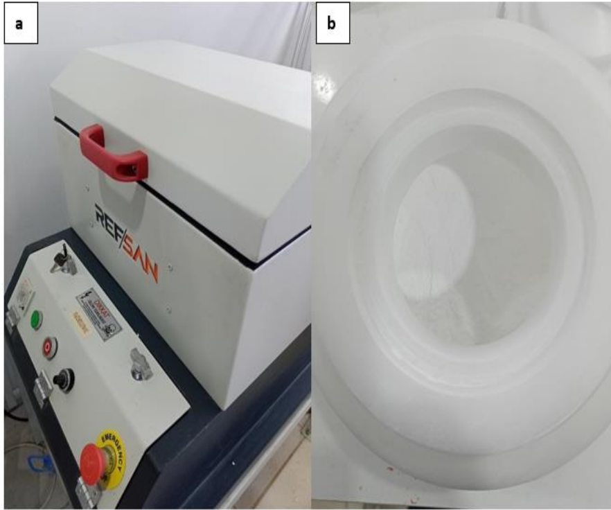
Şekil 6.3. Kompozitlerin hazırlanmasında kullanılan (a) Refsan marka jet değirmen ve (b) hazırlanan karışım
