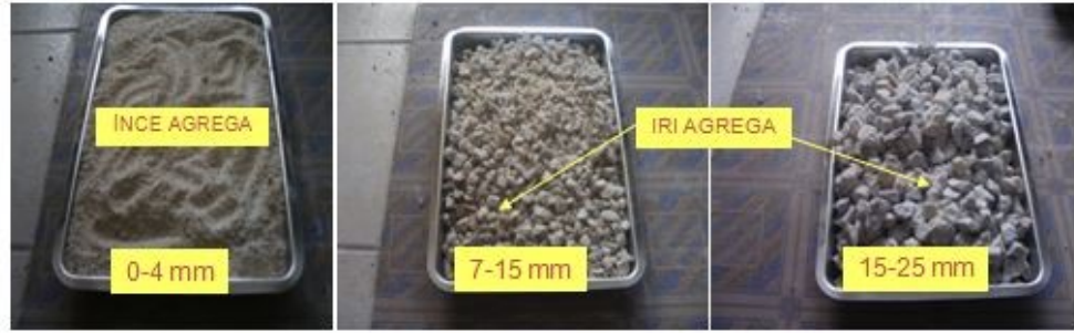
Şekil 3.1. Tane boyutlarına göre agregalar
