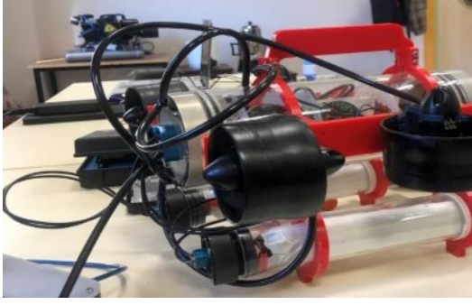
Şekil 3.4. Dört serbestlik dereceli sualtı aracı RedFin ve CAD modeli
