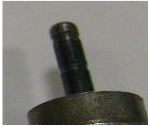
Şekil 5.23: DEN-3 (3 yivli ve 19 mm. boya sahip)
