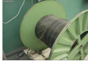
Şekil 4.10: Dış kauçuk katmanın eklenmesi sonrası makaralara sarılması [4]
