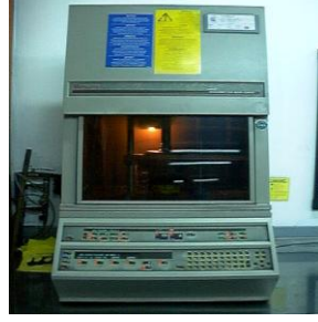
Şekil 2.8: Reometre MDR 2000 E [2]
