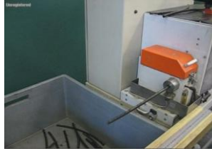
Şekil 4.11: Hortumların istenilen boyutlarda kesilmesi [4]
