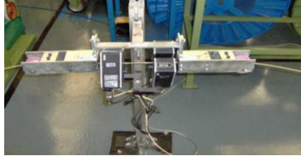
Şekil 4.4: Dalgallılık ve çap kontrolü [4]
