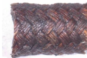
Şekil 5.57: Testler esnasında sızdırmış olan hortum (üst örgü katmanı)
