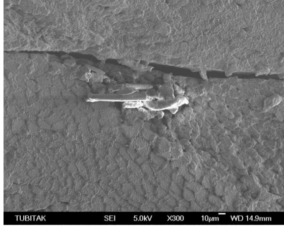
Şekil 5.15: Alt boru ile elyaf ara yüzeyine yakın demetler içerisindeki elyaflarda açılma Kauçuk üst boru/elyaf ara yüzeyi arasında oluşan delaminasyon dışında elyaflar içinde, boru arakesitinde ciddi deformasyonların söz konusu olmadığı görülmektedir.
