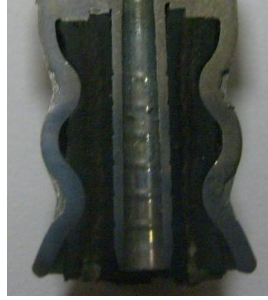
Şekil 5.18: Seri üretim seviyesinde sıkılmış rakor (referans)
