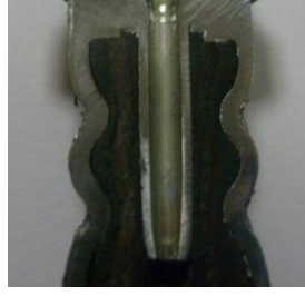
Şekil 5.20: 10,8 iç çapına sahip ve 10,30 mm ye sıkılmış rakor kesiti (DEN-2)
