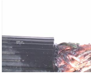
Şekil 5.31: 216 no.lu hortumlarda yerinden çıkma hasarları (yüksek mukavemet)
