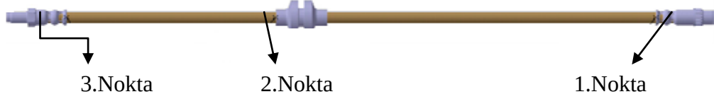
Şekil 4.30: CATIA V5R18 Bilgisayar destekli tasarım programı ile çizilmiş 3 bindirme noktalı fren hortumu [16].
