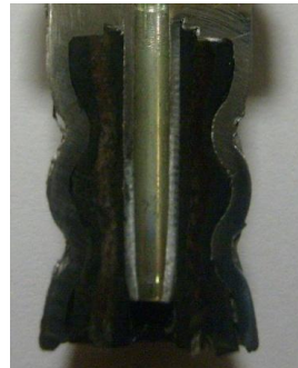
Şekil 5.19: 10,80 mm apında ve 10,1 mm ye sıkılmış rakor (DEN-1)
