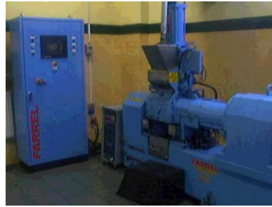
Şekil 2.4: Kapalı karıştırıcı sisteme bir örnek [2]
