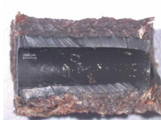
Şekil 5.54: Testler esnasında sızdırma sonrası elyaflarda fitil oluşumu ve sıvının boru eksenini boyunca ilerlemesi
