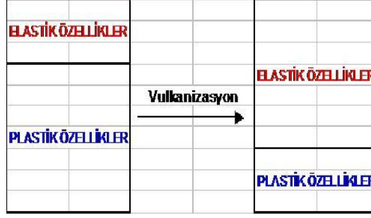
Şekil 2.3: Vulkanizasyon işlemi sonucu kauçuğun elastik özelliklerinin artması
