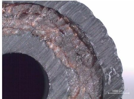
Şekil 5.52: Testler esnasında sızdırmış olan hortumun detay resmi
