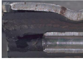
Şekil 5.32: Den 4 tipi rakor (basınçlı fren sıvısının giriş noktası)
