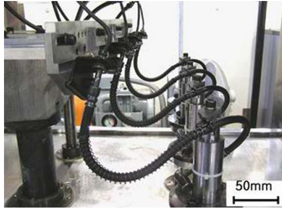
Şekil 4.18: Otomotiv hidrolik frenleri için kauçuk hortum düzeneği sağlamlık test cihazı [13].
