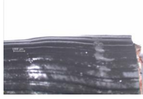
Şekil 5.30: 208 nolu hortumlarda yerinden çıkma hasarları (düşük mukavemet)
