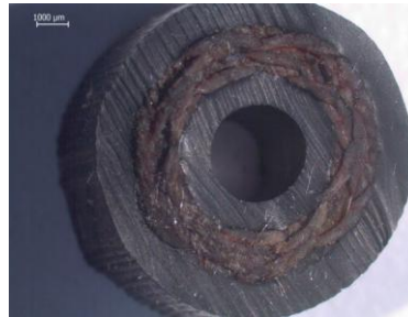
Şekil 5.3: Çekme deneyi sonrası kopma kesitine yakın alınmış bir örnek
