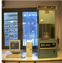
Şekil 2.7: Reometre ODR 100 S [2]
