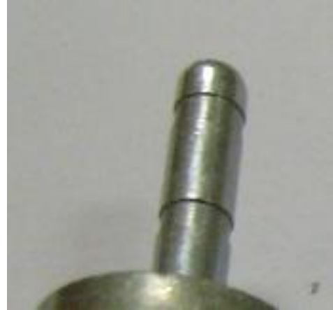
Şekil 5.24: DEN-4 Rakor (3 yivli ve 21 mm. boya sahip)
