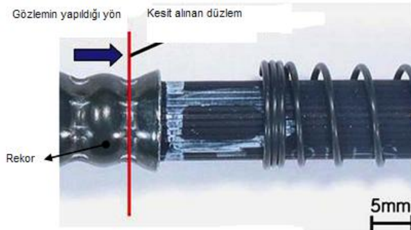
Şekil 4.21: Hata analizi için gözlem yapılan kauçuk hortumu düzlemi [13].
