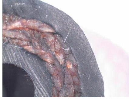
Şekil 5.4: Conti marka hortumda oluşması muhtemel ara yüzey hasarlarına ilişkin fotoğraf
