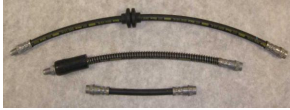
Şekil 4.1: Renault Clio III için üretilmiş fren hortumları [4]
