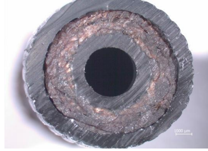
Şekil 5.51: Testler esnasında sızdırmış olan hortum ve çekme deneyi sonrası ortaya çıkan hasar görüntüsü
