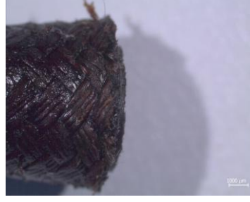
Şekil 5.50: Testler esnasında sızdırmış olan hortumun rakor içerisindeki uç kısmı
