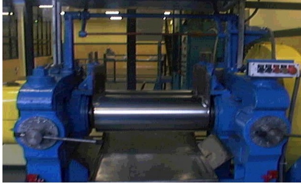
Şekil 2.5: Açık karıştırıcı sisteme bir örnek [2]
