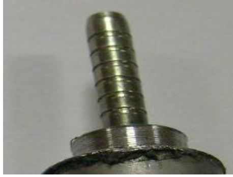
Şekil 5.22: Seri rakor (Referans rakor)
