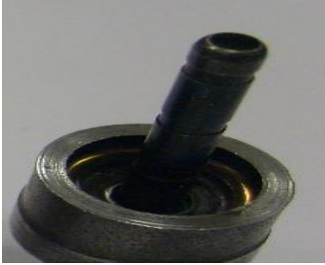
Şekil 5.23: DEN-3 (3 yivli ve 19 mm. boya sahip)
