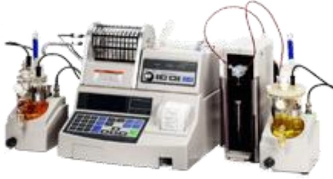
Şekil 4.37: Karl Fischer metodunda kullanılan test düzeneği
