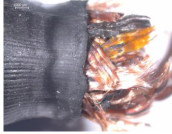
Şekil 5.2: Çekme deneyi sonrası Conti marka fren hortumunun deformasyon sonrası morfolojisi
