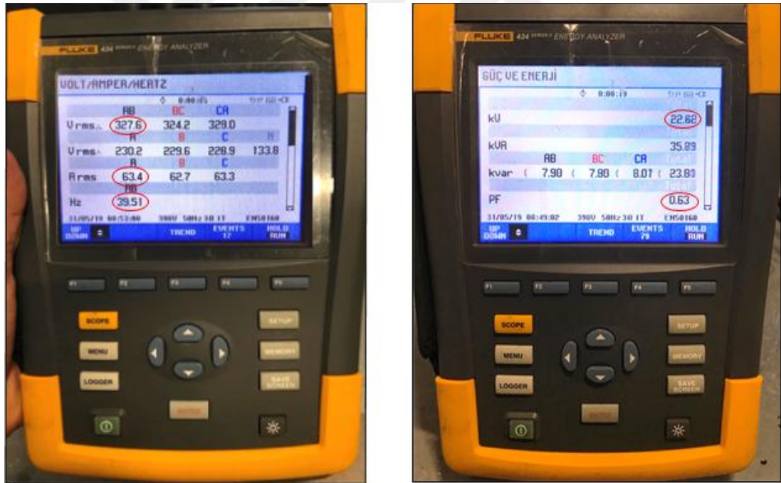
Şekil 4.5. Debimetrenin aktif olduğu durum için ölçüm sonuçları
