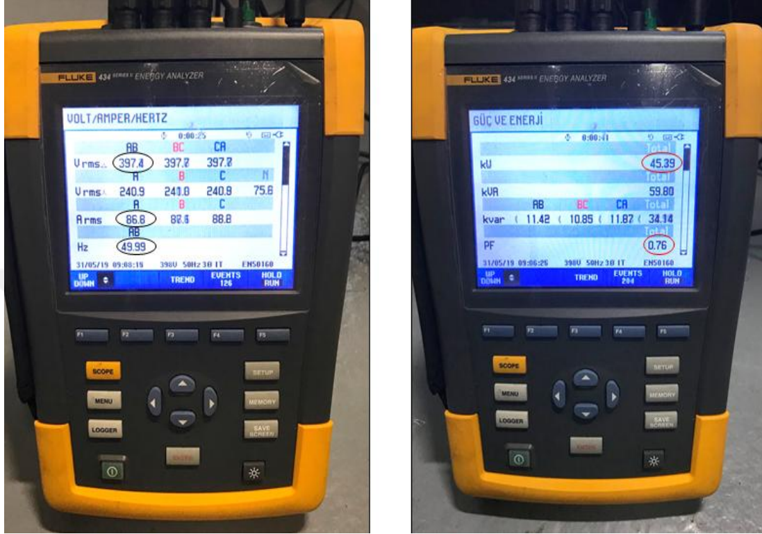
Şekil 4.2. Debimetrenin aktif olmadığı durum için ölçüm sonuçları
